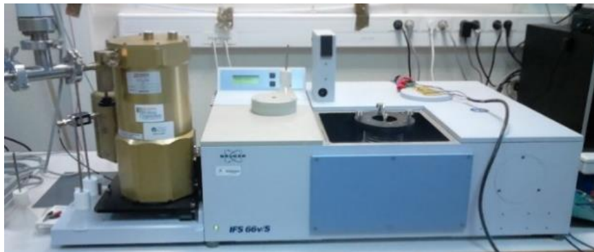
Figure 13 – Photographie du Spectromètre Bruker IFS 66 FTIR utilisé pour les mesures d'infrarouge in situ .
