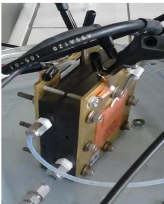
Figure 8 – Photographie de la cellule d'électrolyse utilisée pour les mesures de chronoampérométrie.
