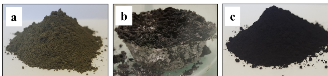
FIGURE 4.12 – Photographie de la poudre de WV4. (a) : mélange avant la réaction SHS; (b) : poudre après réaction SHS; et enfin (c) : poudre obtenue après le protocole de lixiviation, de filtration et de séchage.
