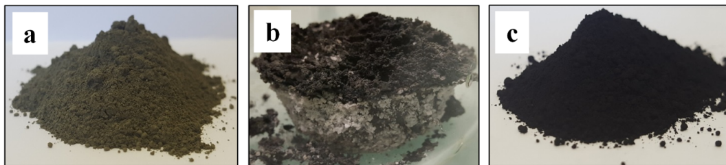
FIGURE 4.12 – Photographie de la poudre de WV4. (a) : mélange avant la réaction SHS; (b) : poudre après réaction SHS; et enfin (c) : poudre obtenue après le protocole de lixiviation, de filtration et de séchage.
