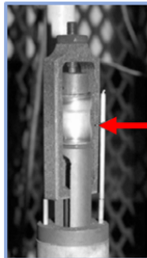
FIGURE 1.16 – Appareil HIP, la flèche rouge indique la capsule après compactage montée sur un dilatomètre [169].
