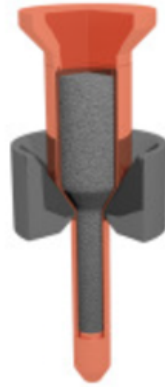
FIGURE 1.19 – Schéma de principe de l'extrusion hydrostatique différentielle; la poudre est encapsulée dans une billette qui, du fait d'une pression amont supérieure à la pression aval, est forcée au travers d'une filière en carbure de tungstène.
