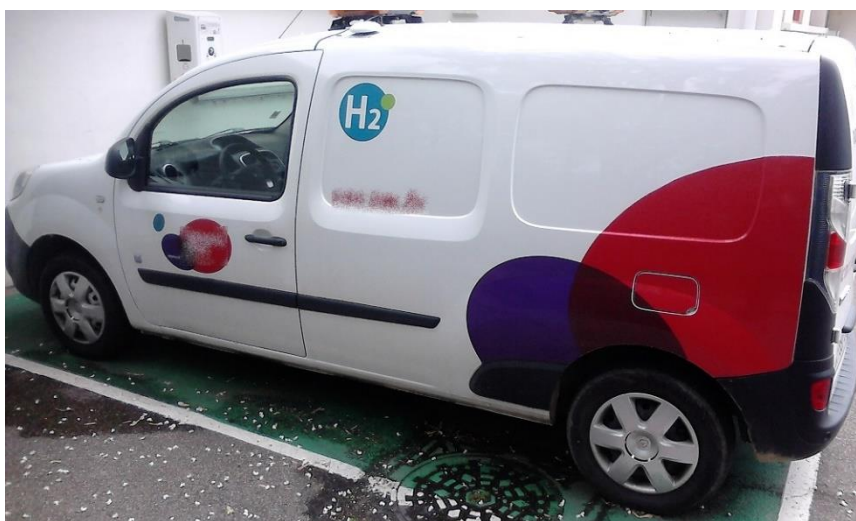
Figure 10. Photographie d'un véhicule utilitaire électrique à prolongateur hydrogène (source : Nicolas Dupuis).
