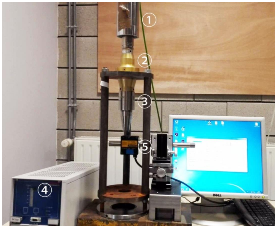
Figure 2.1 Composants du système de fatigue: ① convertisseur, ② amplificateur, ③ sonotrode, ④ générateur, ⑤ capteur laser.
