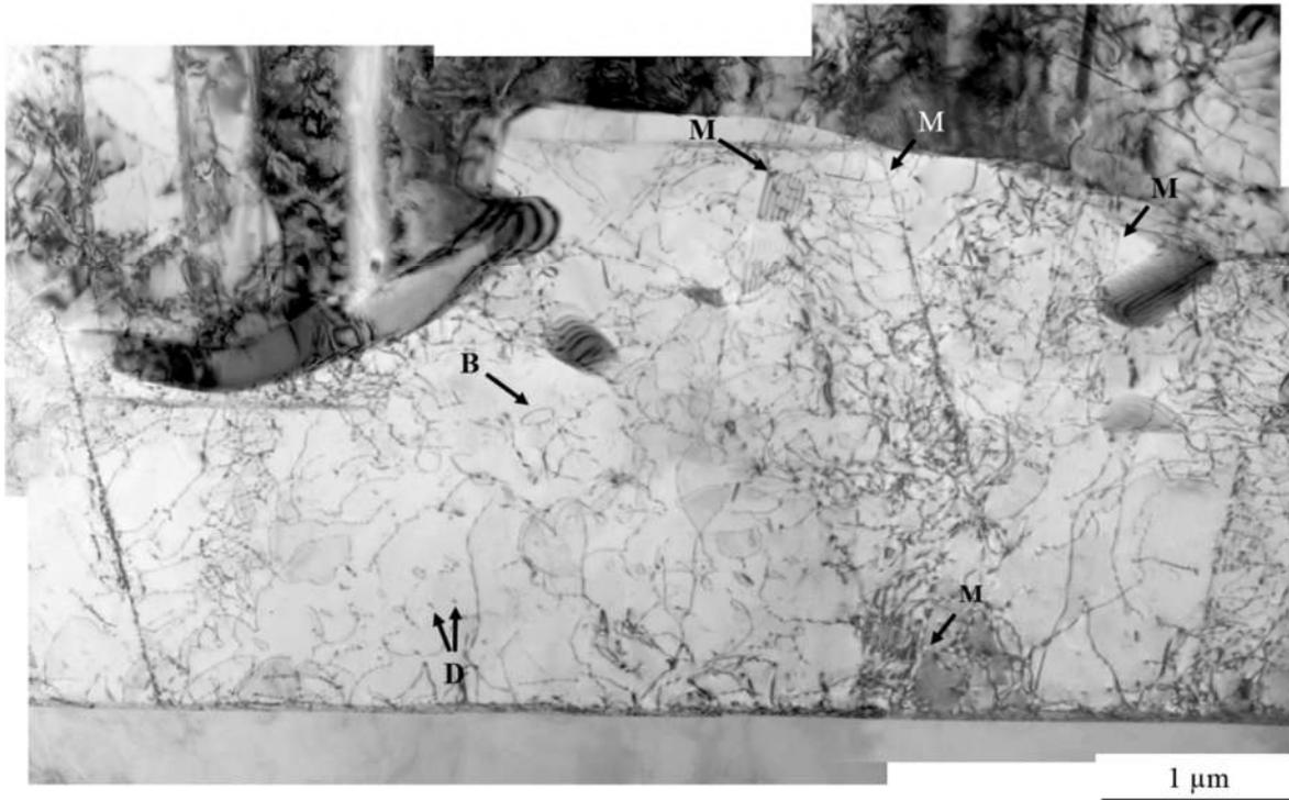
Figure V-16 : Liseré  $\gamma$  de l'échantillon testé à  $\Delta\epsilon_t/2 = 0.3\%$  ;  $T=800^\circ\text{C}$  ;  $N_f=5276$  cycles. B : Boucles ; D : débris ; M : Macles.
