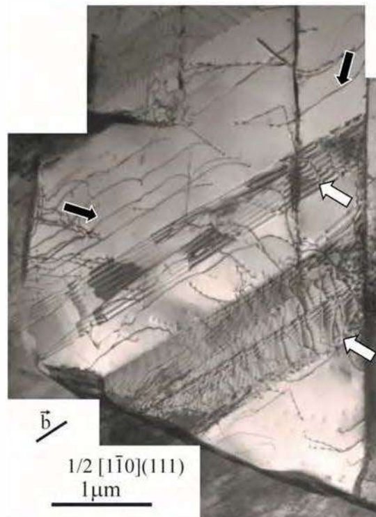
Figure I-10: Liseré \gamma de l'alliage IRIS déformé par glissement de dislocations ordinaires (flèches noires) et maillage (flèches blanches) [2].
