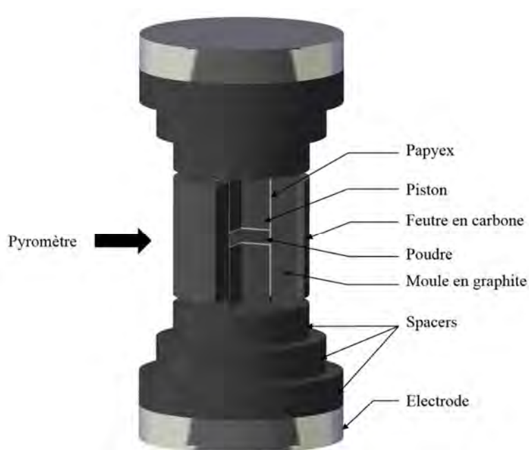
Figure II-5: Système d'encapsulation de la poudre dans la Syntex 2080 [2].
