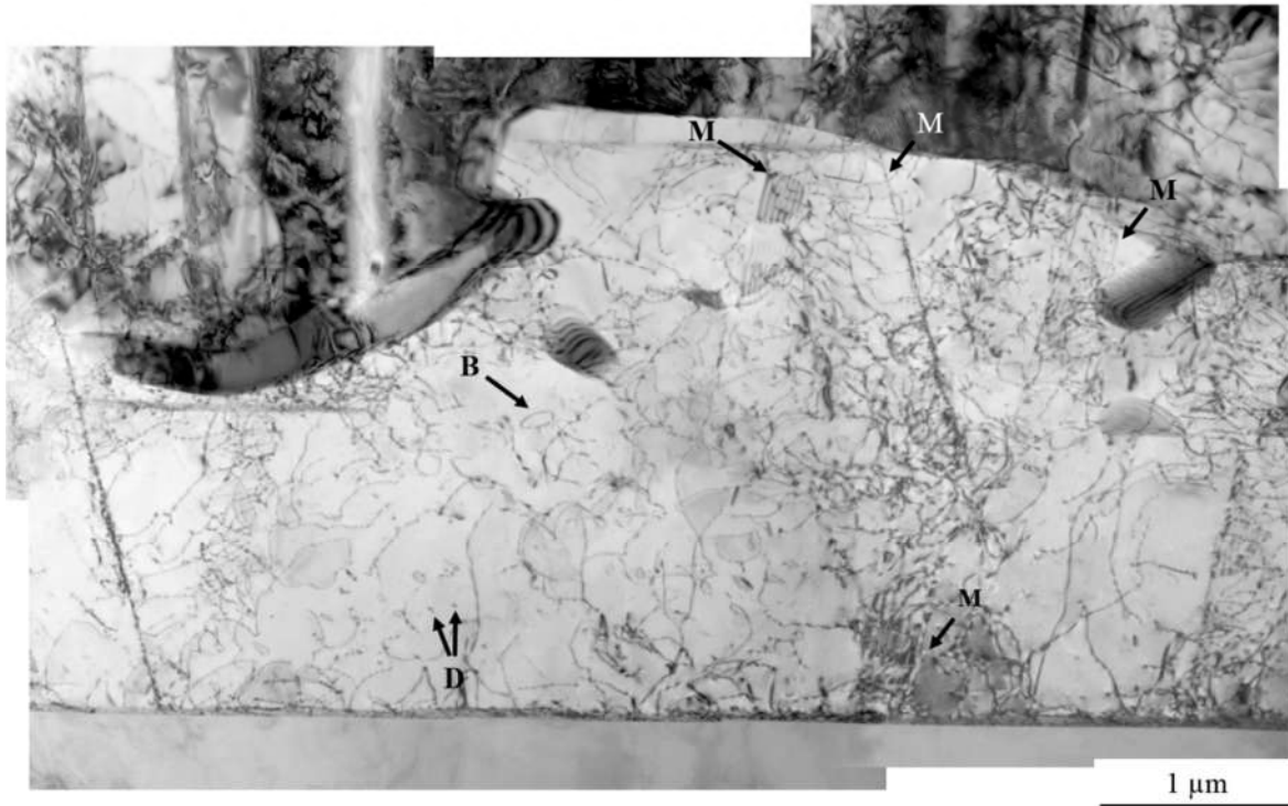
Figure V-16 : Liseré \gamma de l'échantillon testé à \Delta\epsilon_t/2 = 0.3\% ; T=800^\circ\text{C} ; N_f=5276 cycles. B : Boucles ; D : débris ; M : Macles.
