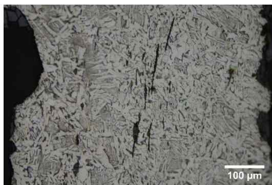
Figure 81 - Micrographie de l'échantillon HPO717 après attaque au réactif Nital 3% présentant une structure de Widmanstätten
