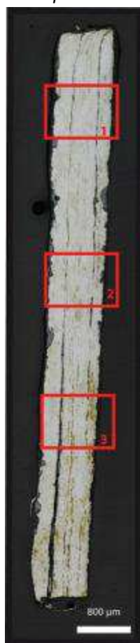
Mosaïque de l'échantillon (après attaque au Nital 3%)
