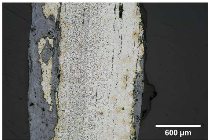
Figure 117 - Micrographies des échantillons 3-4 révélant une structure en bande.
