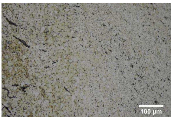
Micrographie 3 : Après attaque au Nital 3%
