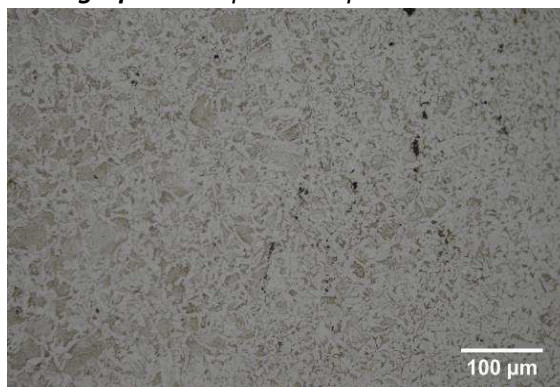
Micrographie 2 : Après attaque au Nital 3%
