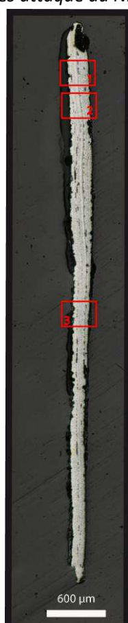
Mosaïque de l'échantillon (après attaque au Nital 3%)
