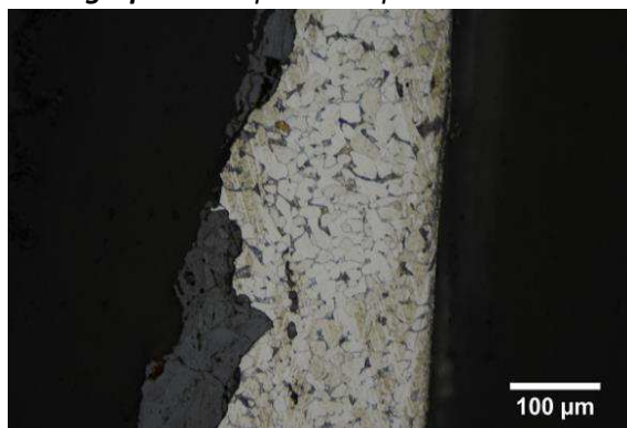
Micrographie 1 : Après attaque au Nital 3%
