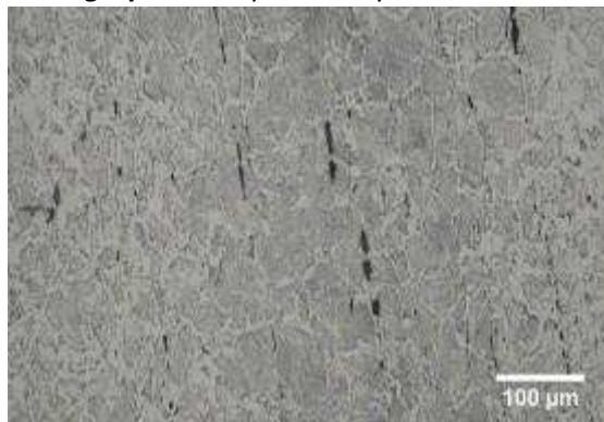
Micrographie 2 : Après attaque au Nital 3%
