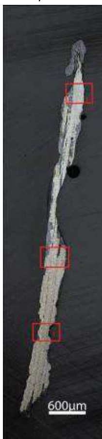
Mosaïque de l'échantillon (après attaque au Nital 3%)
