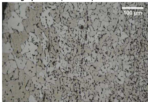
Micrographie 2 : Après attaque au Nital 3%
