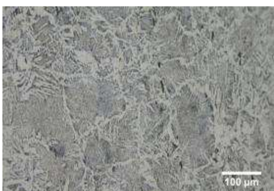
Micrographie 3 : Après attaque au Nital 3%
