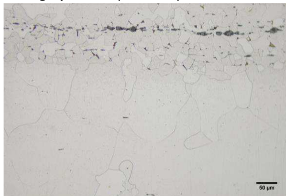
Micrographie 2 : Après attaque au Nital 3%
