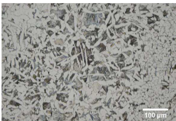
Micrographie 3 : Après attaque au Nital 3%
