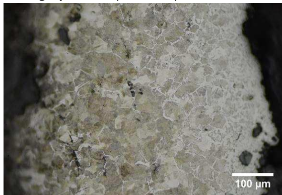
Micrographie 2 : Après attaque au Nital 3%
