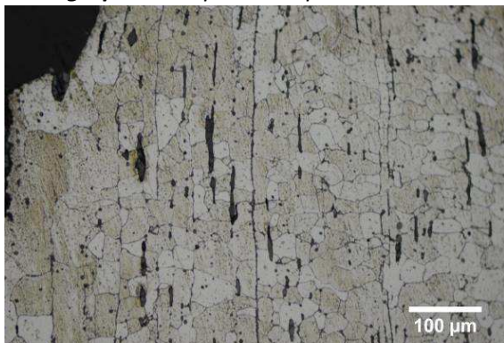
Micrographie 1 : Après attaque au Nital 3%
