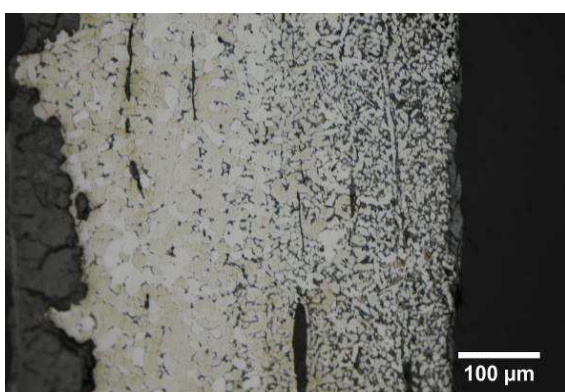
Micrographie 3 : Après attaque au Nital 3%
