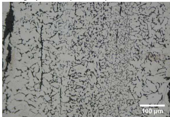
Micrographie 2 : Après attaque au Nital 3%
