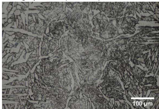
Micrographie 2 : Après attaque au Nital 3%
