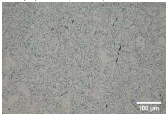
Micrographie 2 : Après attaque au Nital 3%
