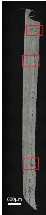
Mosaïque de l'échantillon (après attaque au Nital 3%)
