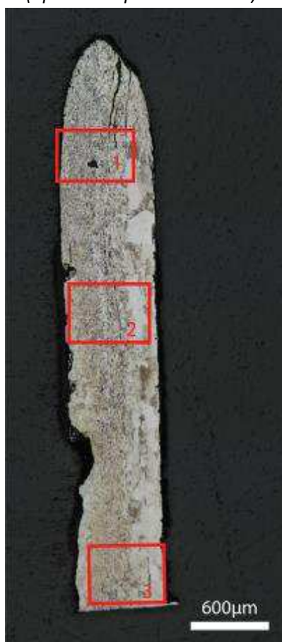
Mosaïque de l'échantillon (après attaque au Nital 3%)
