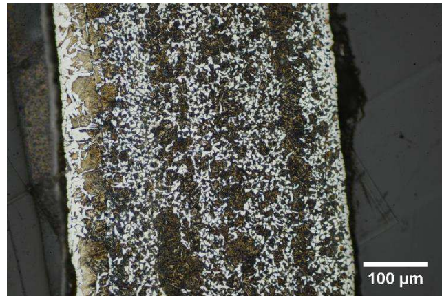
Figure 173 - micrographie de l'échantillon G436_ech1 après attaque au réactif Nital 3%.
