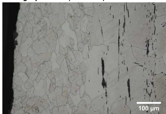
Micrographie 2 : Après attaque au Nital 3%
