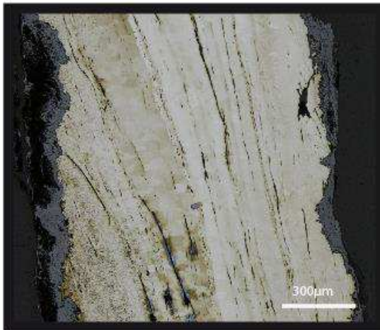
micrographie 2 Après attaque chimique à l'Oberhoffer
