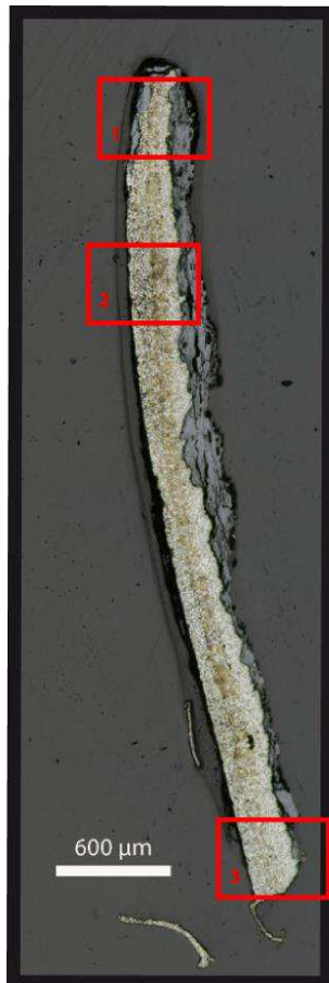
Mosaïque de l'échantillon (après attaque au Nital 3%)
