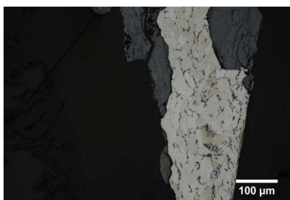
Micrographie 3 : Après attaque au Nital 3%
