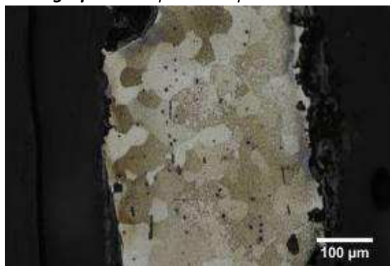
Micrographie 1 : Après attaque au Nital 3%
