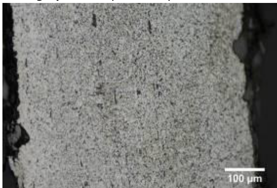
Micrographie 1 : Après attaque au Nital 3%
