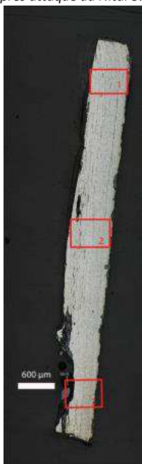
Mosaïque de l'échantillon (après attaque au Nital 3%)
