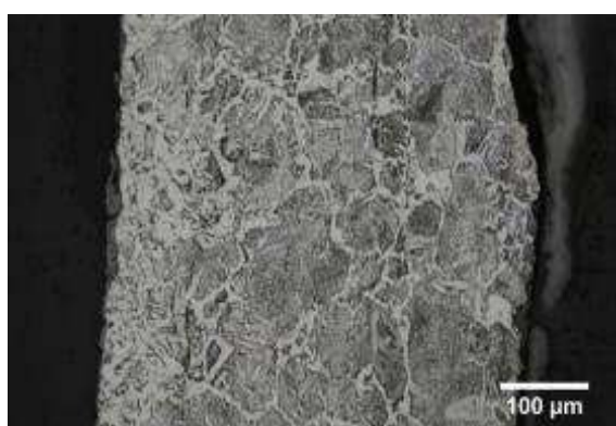
Micrographie 3 : Après attaque au Nital 3%
