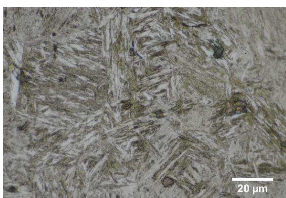
Micrographie 3 : Après attaque au Nital 3%
