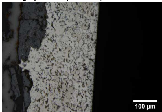
Micrographie 2 : Après attaque au Nital 3%
