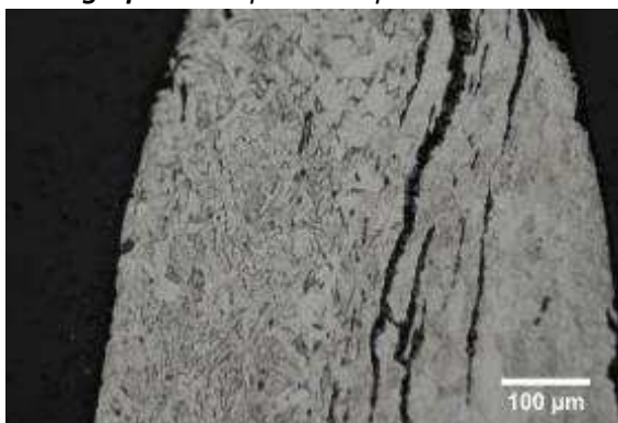
Micrographie 1 : Après attaque au Nital 3%
