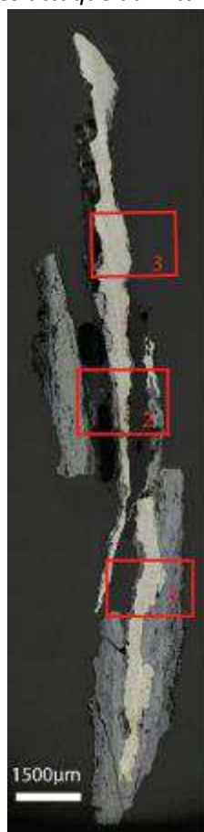
Mosaïque de l'échantillon (après attaque au Nital 3%)
