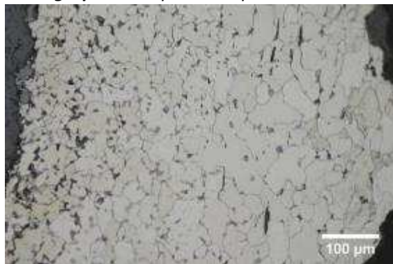
Micrographie 2 : Après attaque au Nital 3%
