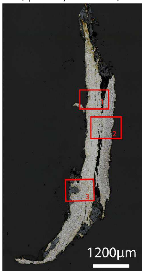
Mosaïque de l'échantillon (après attaque au Nital 3%)
