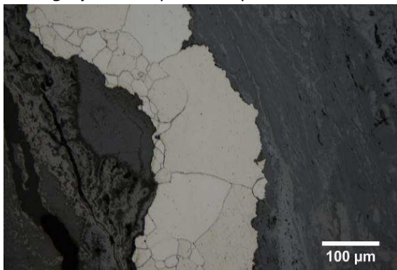
Micrographie 1 : Après attaque au Nital 3%
