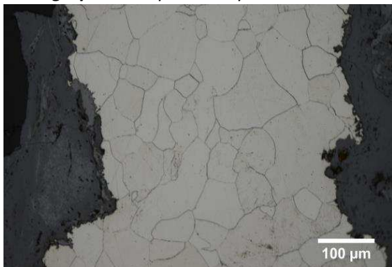
Micrographie 1 : Après attaque au Nital 3%
