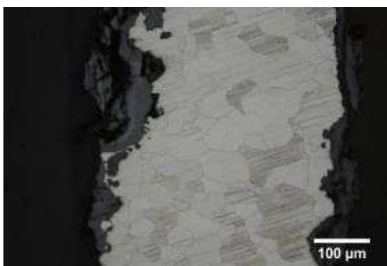
Micrographie 3 : Après attaque au Nital 3%
