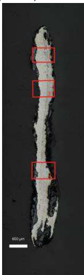
Mosaïque de l'échantillon (après attaque au Nital 3%)
