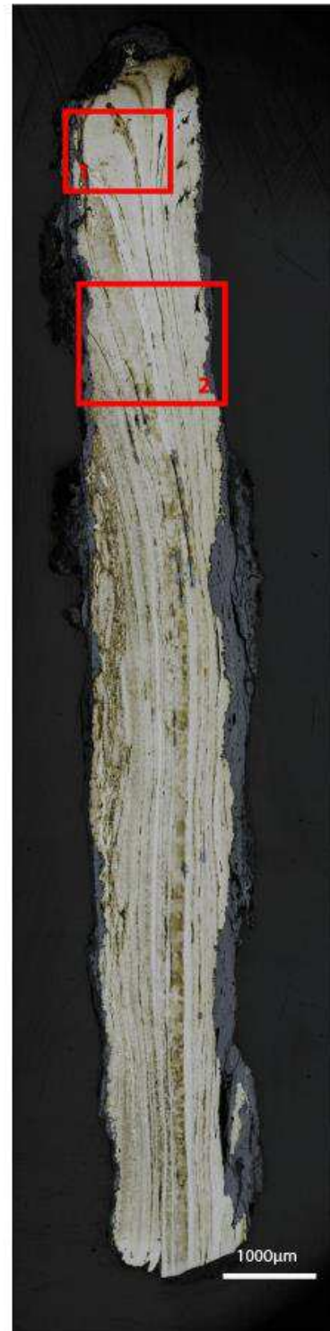
Figure 55 - Exemple d'analyse métallographique après attaque au réactif Oberhoffer sur l'échantillon 34820434 La micrographie 1 met en évidence des « structures fantômes » témoins de la présence de phosphore en solution solide. Les lignes blanches sur la micrographie 2 pourraient correspondre à des lignes de soudure
