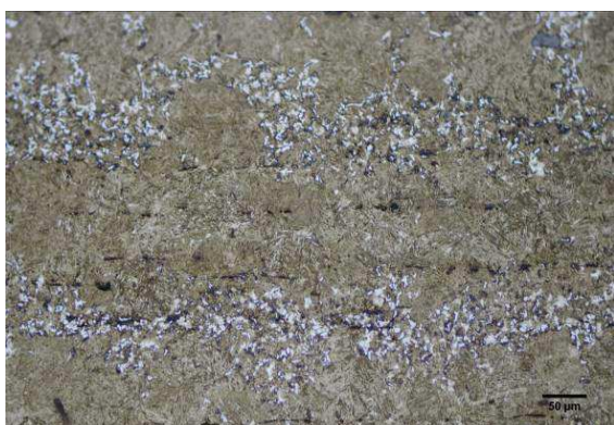
Micrographie 3 : Après attaque au Nital 3%
