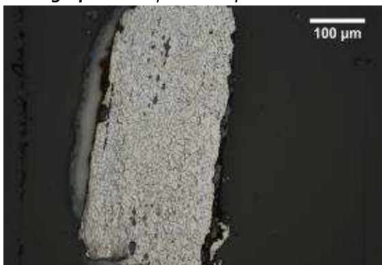
Micrographie 1 : Après attaque au Nital 3%
