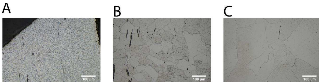
Figure 66 - « A » micrographie après attaque au réactif Nital 3% de l'échantillon 8_dossière de l'armure de François de Montmorency, illustrant la catégorie de taille de grain faible (<50 \mu\text{m} ). « B » micrographie après attaque au réactif Nital 3% de l'échantillon LAM46521 illustrant la catégorie de taille de grain moyenne comprise entre [50-200 \mu\text{m} ]. « C » micrographie après attaque au réactif Nital 3% de l'échantillon Laq_348214425 illustrant la catégorie de taille de grain élevée supérieure à 200 \mu\text{m} .
