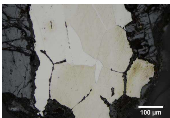
Micrographie 3 : Après attaque au Nital 3%
