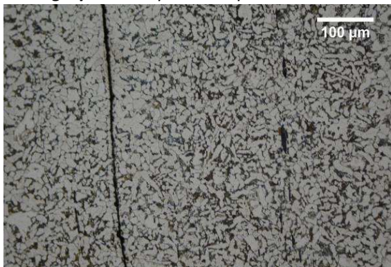
Micrographie 1 : Après attaque au Nital 3%
