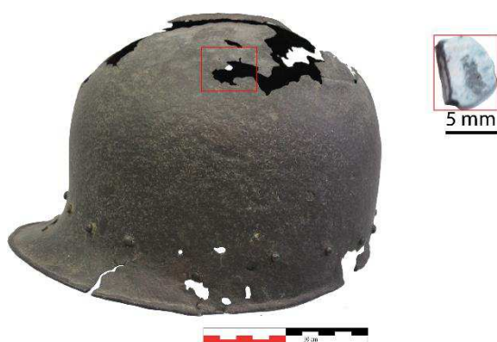
Figure 35 -Exemple de positionnement d'un prélèvement effectué sur une salade du musée de l'Armée. A droite, prélèvement résultant (cliché E. Bérard)
