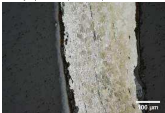
Micrographie 2 : Après attaque au Nital 3%
