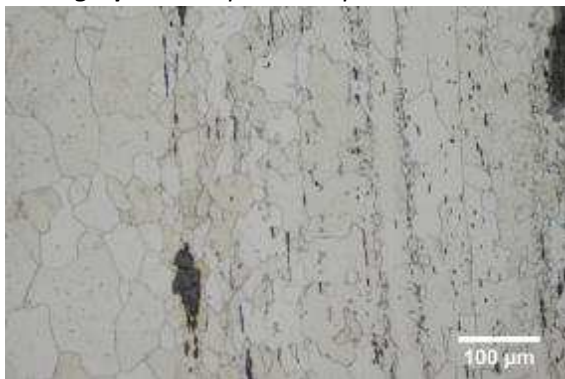
Micrographie 1 : Après attaque au Nital 3%
