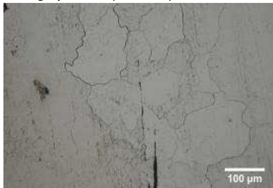
Micrographie 2 : Après attaque au Nital 3%
