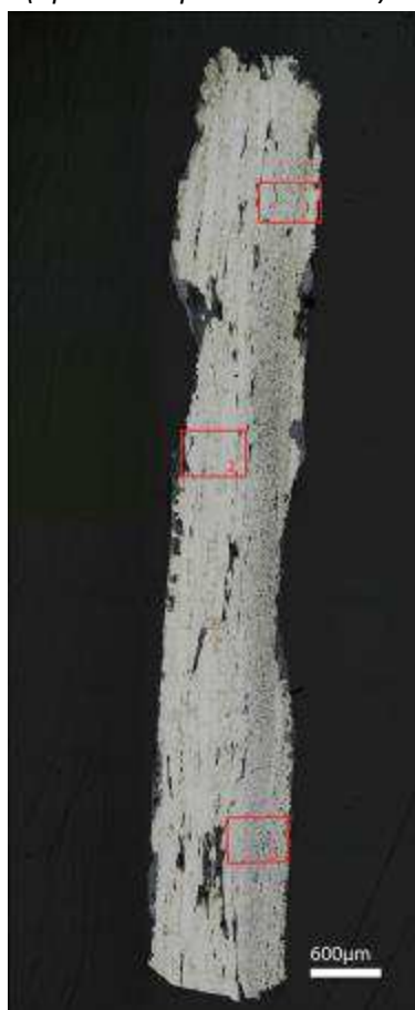
Mosaïque de l'échantillon (après attaque au Nital 3%)
