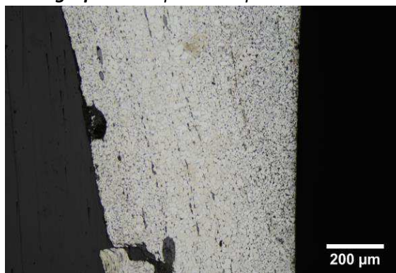
Micrographie 2 : Après attaque au Nital 3%
