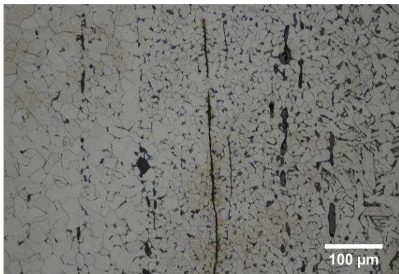
Micrographie 3 : Après attaque au Nital 3%
