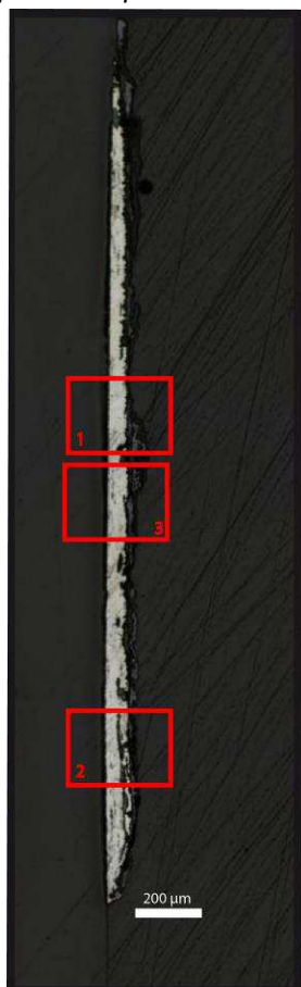
Mosaïque de l'échantillon (après attaque au Nital 3%)
