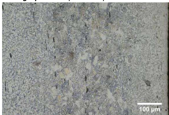
Micrographie 1 : Après attaque au Nital 3%
