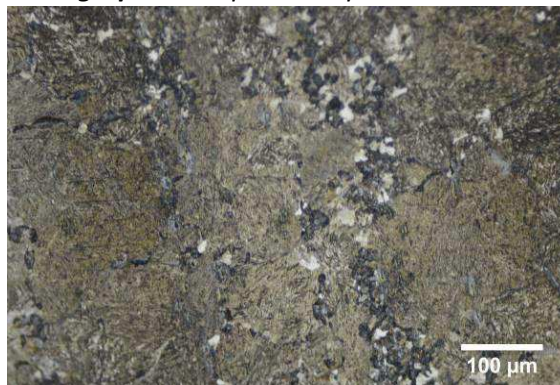
Micrographie 2 : Après attaque au Nital 3%
