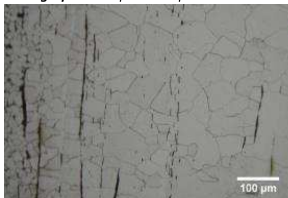
Micrographie 2 : Après attaque au Nital 3%
