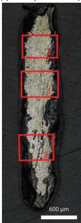
Mosaïque de l'échantillon (après attaque au Nital 3%)
