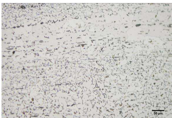
Micrographie 3 : Après attaque au Nital 3%
