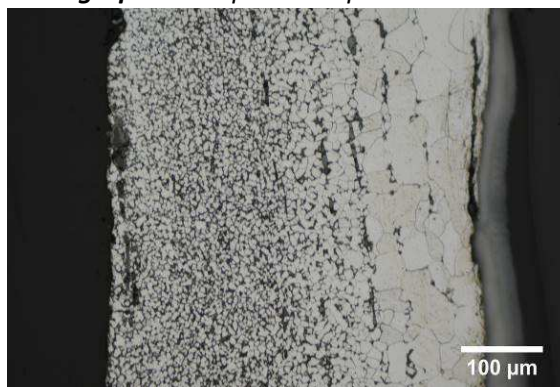
Micrographie 2 : Après attaque au Nital 3%
