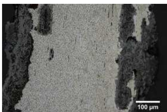
Micrographie 3 : Après attaque au Nital 3%
