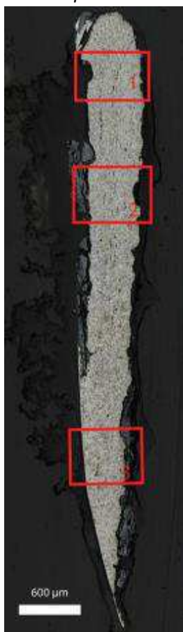
Mosaïque de l'échantillon (après attaque au Nital 3%)
