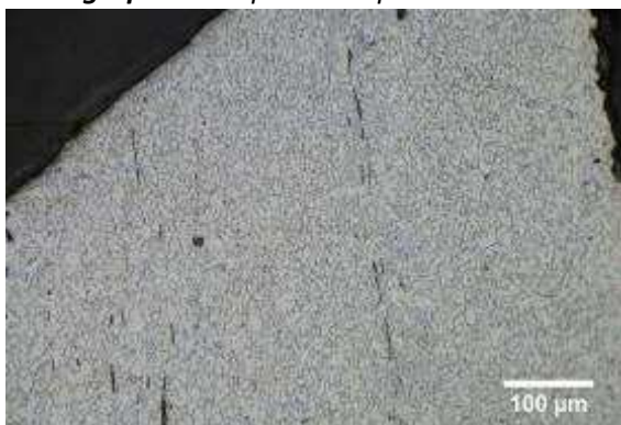
Micrographie 1 : Après attaque au Nital 3%
