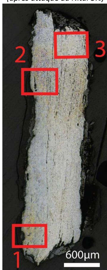
Mosaïque de l'échantillon (après attaque au Nital 3%)
