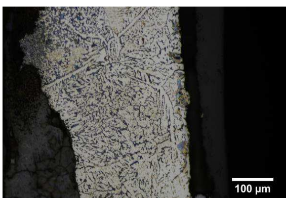
Micrographie 3 : Après attaque au Nital 3%
