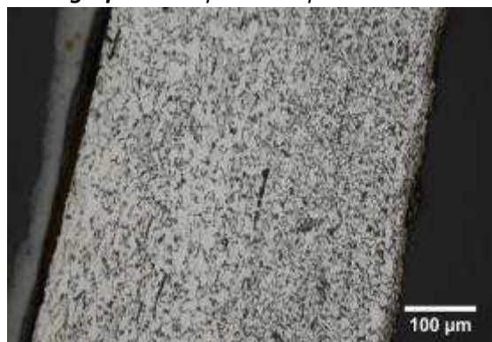
Micrographie 2 : Après attaque au Nital 3%
