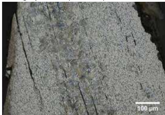
Micrographie 2 : Après attaque au Nital 3%
