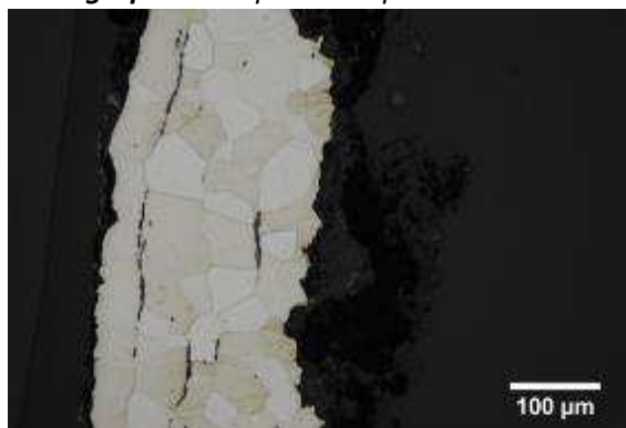
Micrographie 1 : Après attaque au Nital 3%
