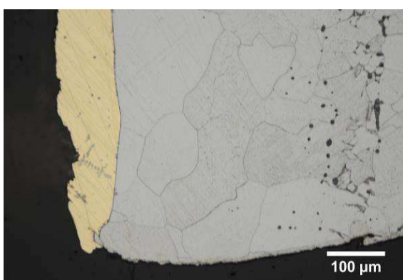
Micrographie 3 : Après attaque au Nital 3%
