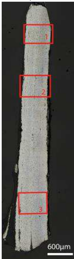
Mosaïque de l'échantillon (après attaque au Nital 3%)
