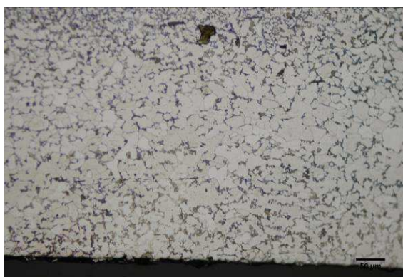
Micrographie 3 : Après attaque au Nital 3%
