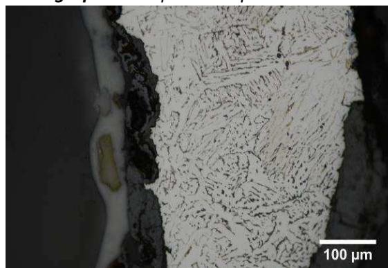
Micrographie 2 : Après attaque au Nital 3%
