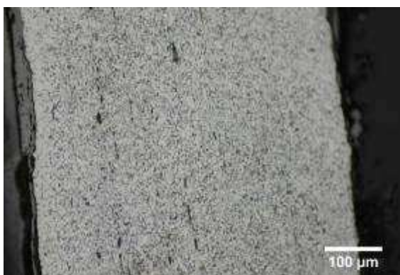
Micrographie 3 : Après attaque au Nital 3%
