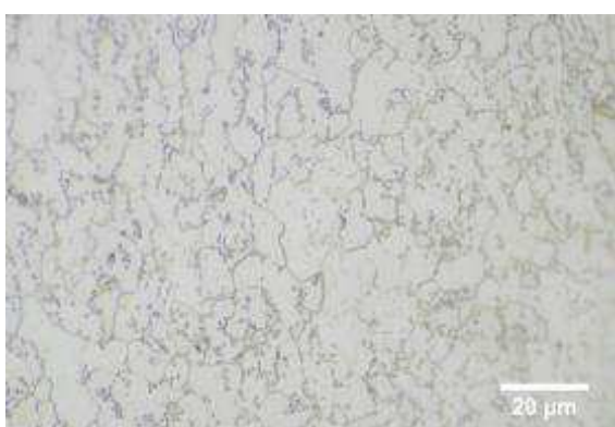
Micrographie 3 : Après attaque au Nital 3%
