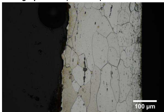
Micrographie 1 : Après attaque au Nital 3%
