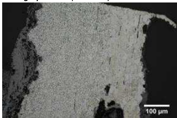
Micrographie 1 : Après attaque au Nital 3%
