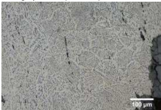
Micrographie 1 : Après attaque au Nital 3%
