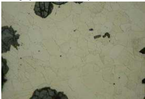
Micrographie 1 : Après attaque au Nital 3%
