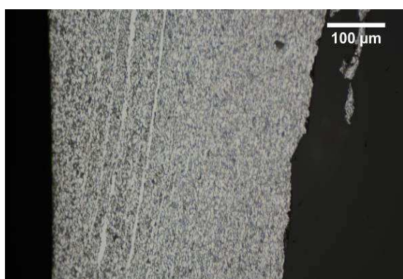
Micrographie 3 : Après attaque au Nital 3%
