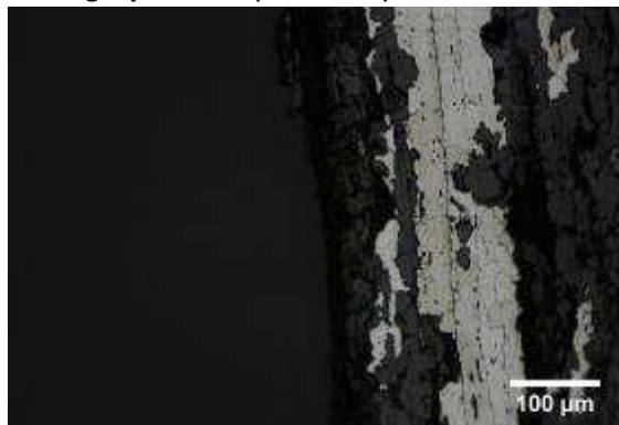
Micrographie 2 : Après attaque au Nital 3%
