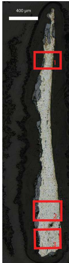
Mosaïque de l'échantillon (après attaque au Nital 3%)
