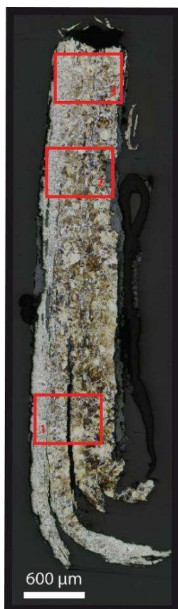
Mosaïque de l'échantillon (après attaque au Nital 3%)
