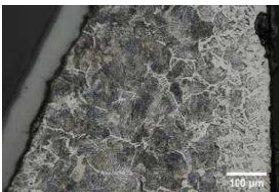
Micrographie 3 : Après attaque au Nital 3%
