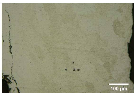
Micrographie 3 : Après attaque au Nital 3%
