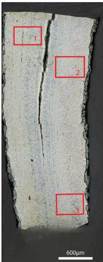
Mosaïque de l'échantillon (après attaque au Nital 3%)
