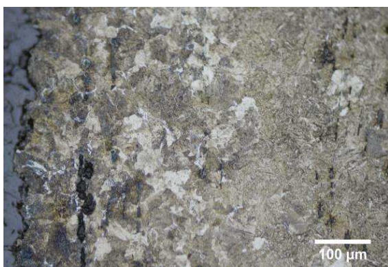
Micrographie 3 : Après attaque au Nital 3%
