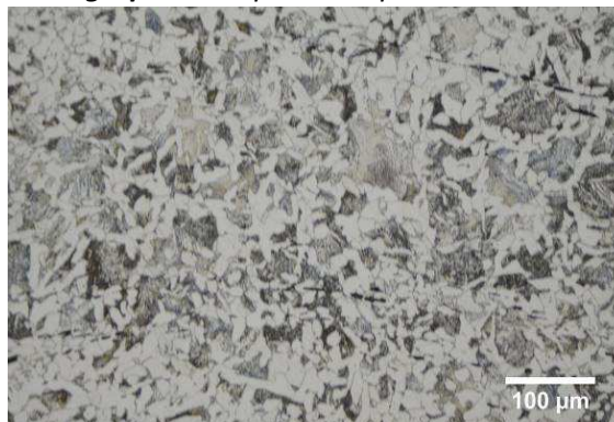
Micrographie 2 : Après attaque au Nital 3%
