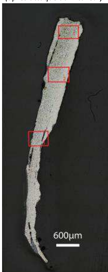
Mosaïque de l'échantillon (après attaque au Nital 3%)
