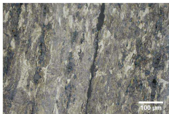
Figure 74 - « A » : Structure écrouie d'un métal ferritique (micrographie de l'échantillon 771 obtenue après attaque Nital 3%), « B » Structure écrouie d'un métal aciéré ( \%C > 0,6 ) (micrographie de l'échantillon STS_10 obtenue après attaque Nital 3%)
