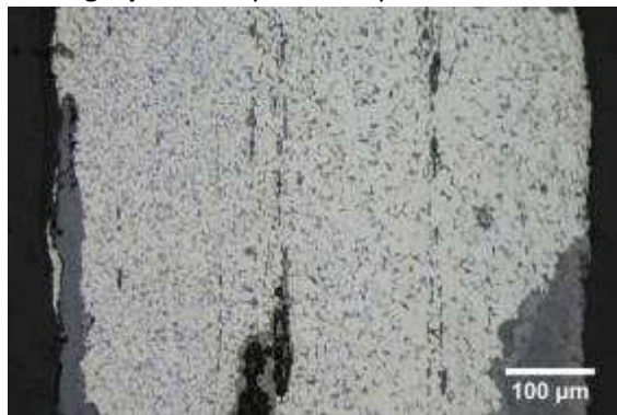
Micrographie 2 : Après attaque au Nital 3%
