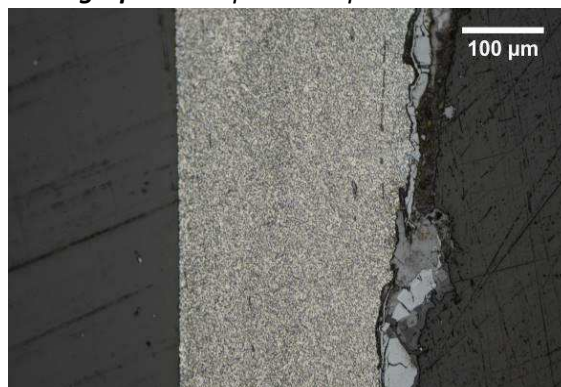
Micrographie 2 : Après attaque au Nital 3%
