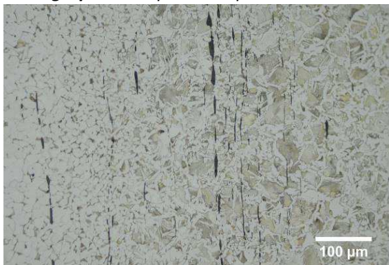
Micrographie 1 : Après attaque au Nital 3%
