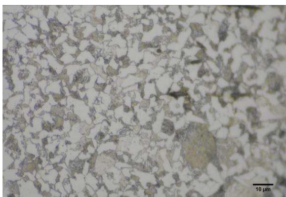
Micrographie 3 : Après attaque au Nital 3%
