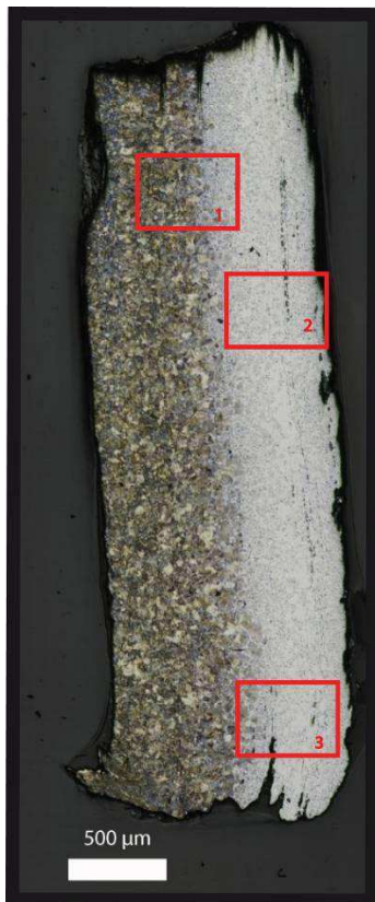
Mosaïque de l'échantillon (après attaque au Nital 3%)
