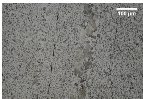
Micrographie 3 : Après attaque au Nital 3%
