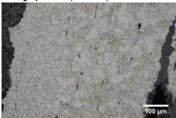
Micrographie 1 : Après attaque au Nital 3%
