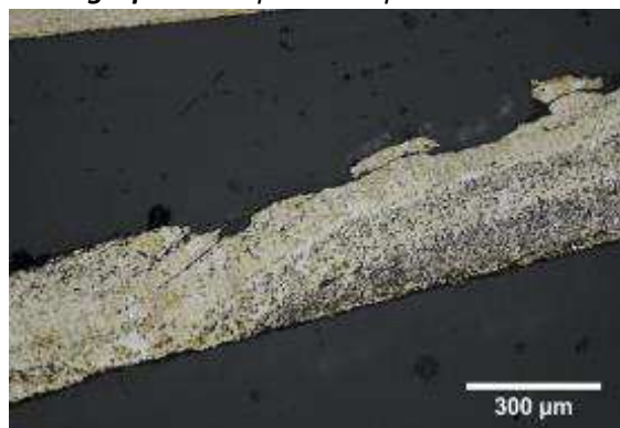
Micrographie 2 : Après attaque au Nital 3%
