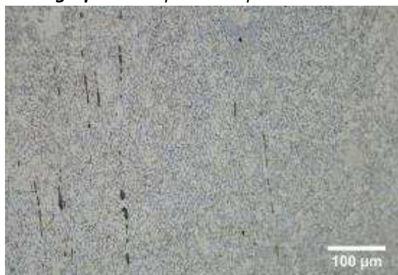
Micrographie 2 : Après attaque au Nital 3%
