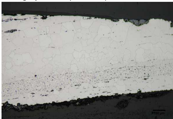
Micrographie 1 : Après attaque au Nital 3%
