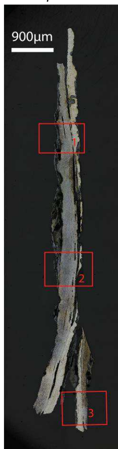
Mosaïque de l'échantillon (après attaque au Nital 3%)
