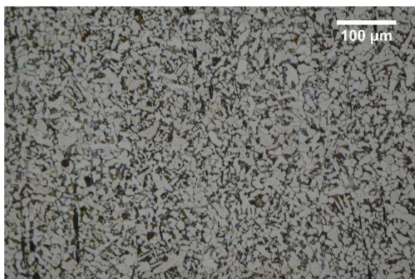
Figure 63- « A » exemple de structure homogène, (échantillon G42_ech2), « B » exemple de structure hétérogène (échantillon 9_dossier). Micrographies observées après attaque au réactif Nital 3%
