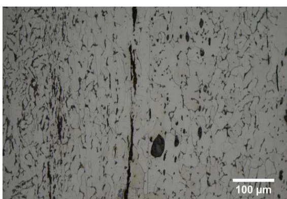
Micrographie 3 : Après attaque au Nital 3%
