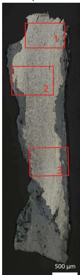
Mosaïque de l'échantillon (après attaque au Nital 3%)
