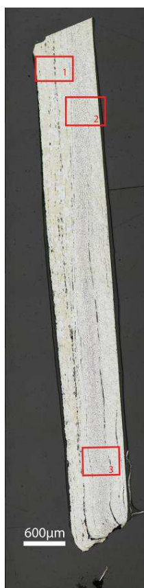
Mosaïque de l'échantillon (après attaque au Nital 3%)
