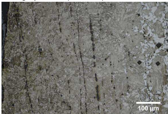
Micrographie 1 : Après attaque au Nital 3%
