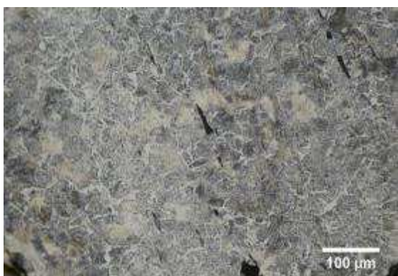
Micrographie 3 : Après attaque au Nital 3%
