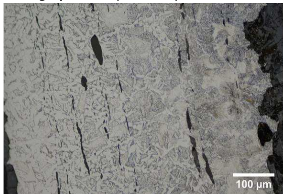
Micrographie 2 : Après attaque au Nital 3%
