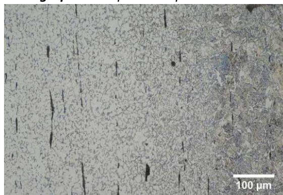
Micrographie 2 : Après attaque au Nital 3%
