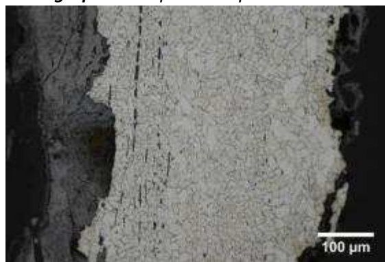
Micrographie 2 : Après attaque au Nital 3%
