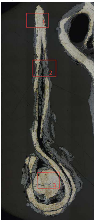
Mosaïque de l'échantillon (après attaque au Nital 3%)
