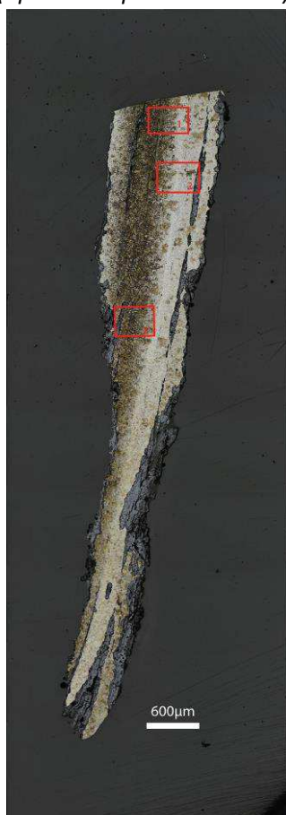
Mosaïque de l'échantillon (après attaque au Nital 3%)
