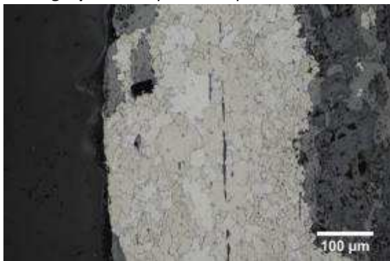
Micrographie 1 : Après attaque au Nital 3%
