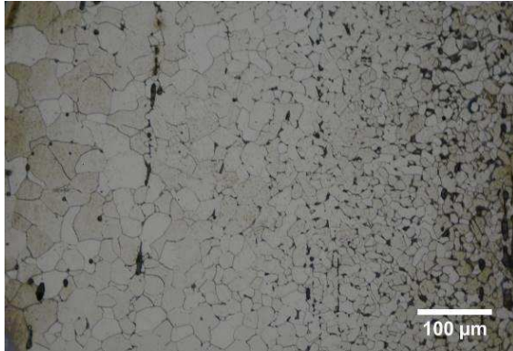
Micrographie 1 : Après attaque au Nital 3%
