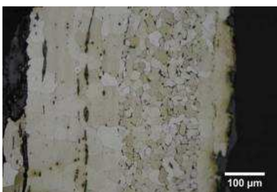
Micrographie 3 : Après attaque au Nital 3%
