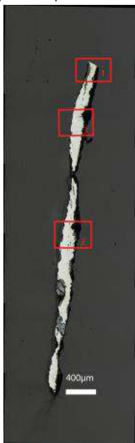
Mosaïque de l'échantillon (après attaque au Nital 3%)
