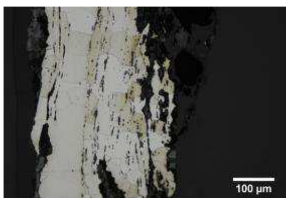
Micrographie 3 : Après attaque au Nital 3%
