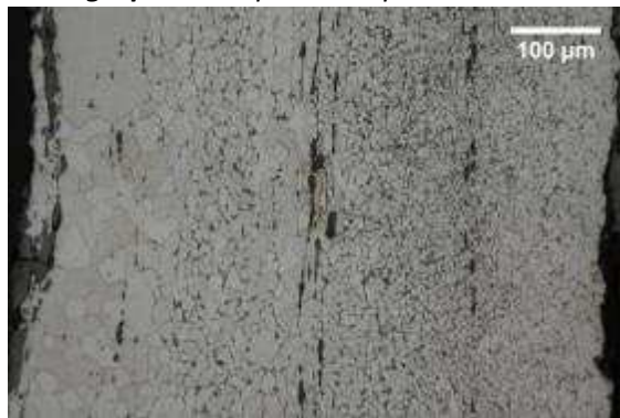
Micrographie 2 : Après attaque au Nital 3%
