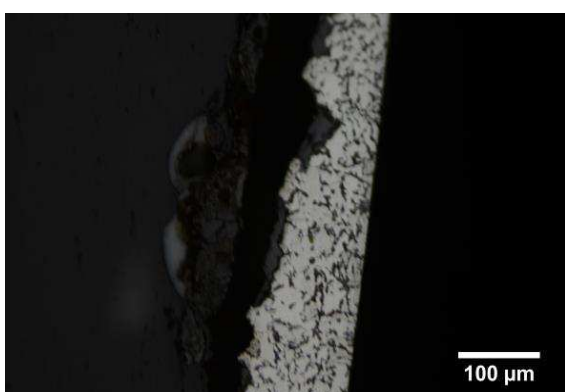
Micrographie 3 : Après attaque au Nital 3%
