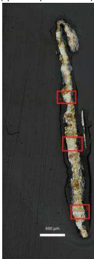
Mosaïque de l'échantillon (après attaque au Nital 3%)
