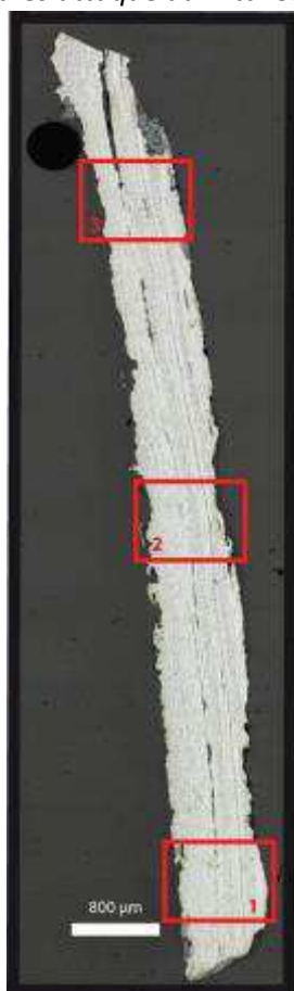
Mosaïque de l'échantillon (après attaque au Nital 3%)
