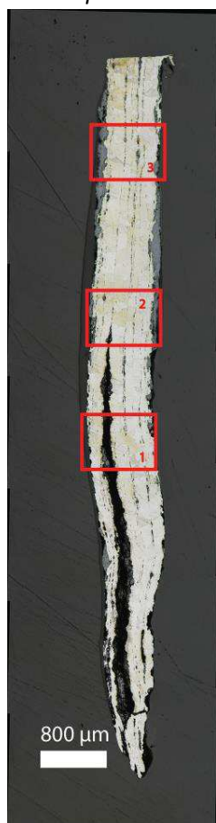
Mosaïque de l'échantillon (après attaque au Nital 3%)
