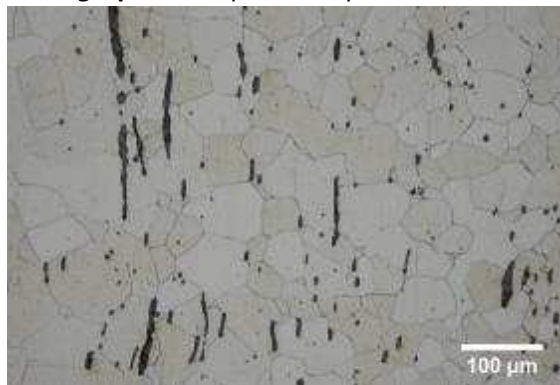
Micrographie 2 : Après attaque au Nital 3%
