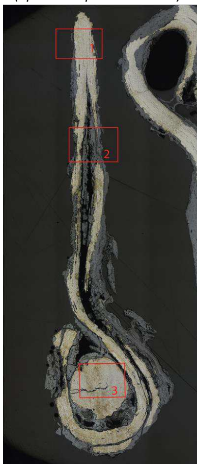
Mosaïque de l'échantillon (après attaque au Nital 3%)
