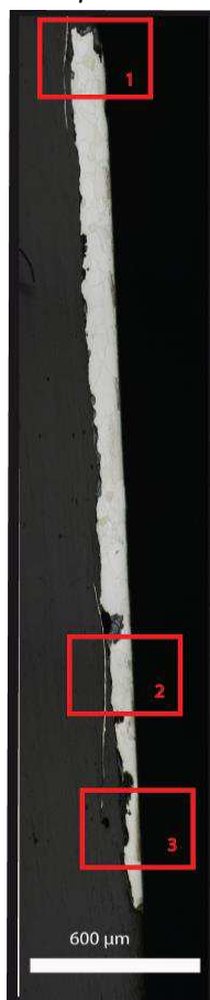
Mosaïque de l'échantillon (après attaque au Nital 3%)
