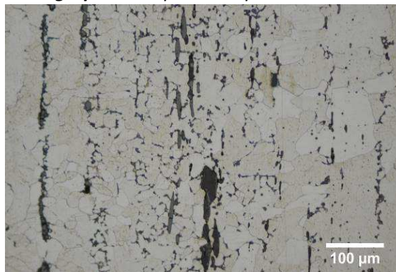
Micrographie 2 : Après attaque au Nital 3%
