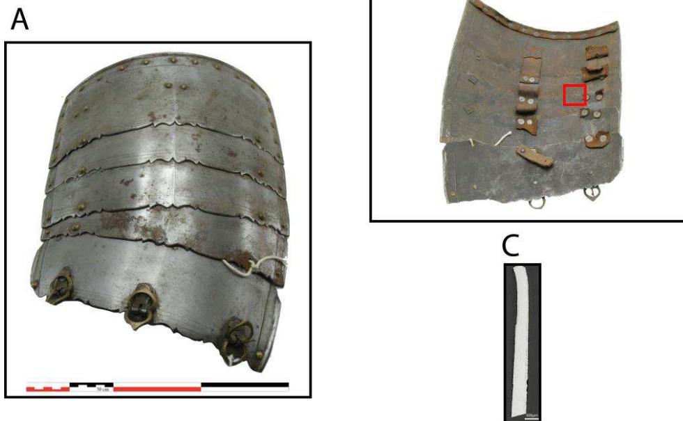
« A » : Photographie de la pièce complète, « B » : repérage du prélèvement, « C » : vue en coupe transversale de l'échantillon
