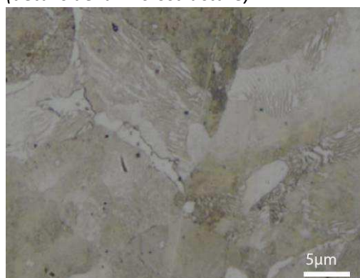
Micrographie 4 : Après attaque au Nital 3% (détails de la microstructure)
