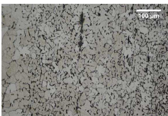
Micrographie 3 : Après attaque au Nital 3%
