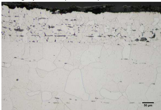
Micrographie 1 : Après attaque au Nital 3%
