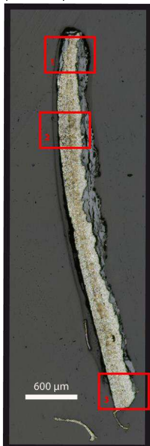
Mosaïque de l'échantillon (après attaque au Nital 3%)
