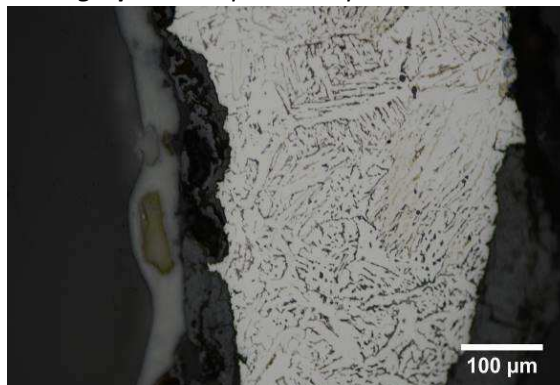
Micrographie 2 : Après attaque au Nital 3%
