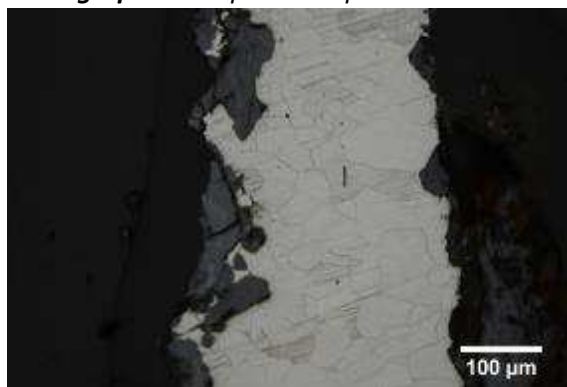
Micrographie 1 : Après attaque au Nital 3%
