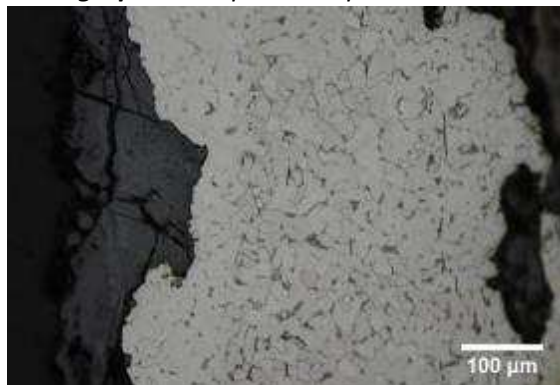
Micrographie 2 : Après attaque au Nital 3%
