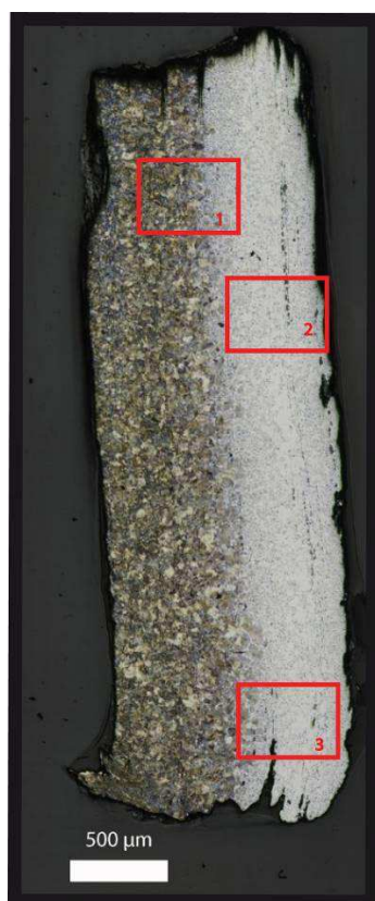
Mosaïque de l'échantillon (après attaque au Nital 3%)
