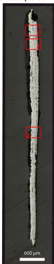
Mosaïque de l'échantillon (après attaque au Nital 3%)
