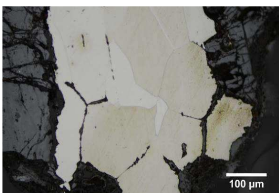
Micrographie 3 : Après attaque au Nital 3%
