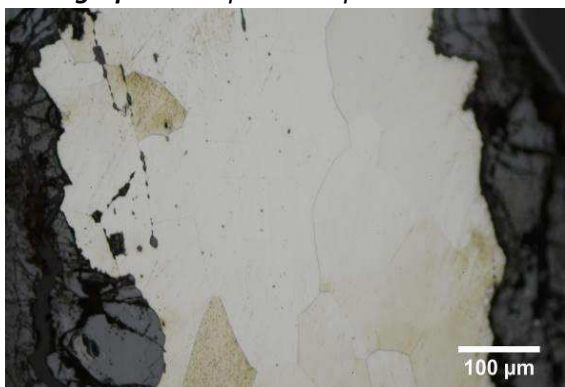
Micrographie 1 : Après attaque au Nital 3%
