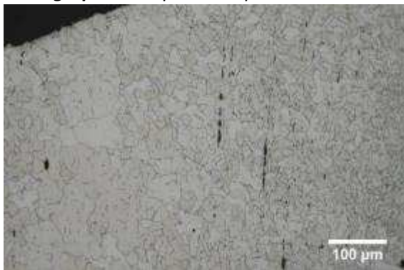
Micrographie 1 : Après attaque au Nital 3%
