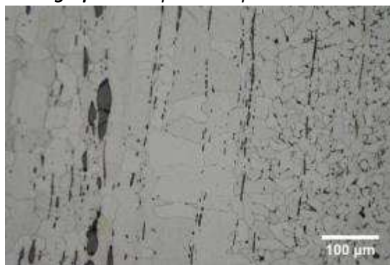
Micrographie 2 : Après attaque au Nital 3%
