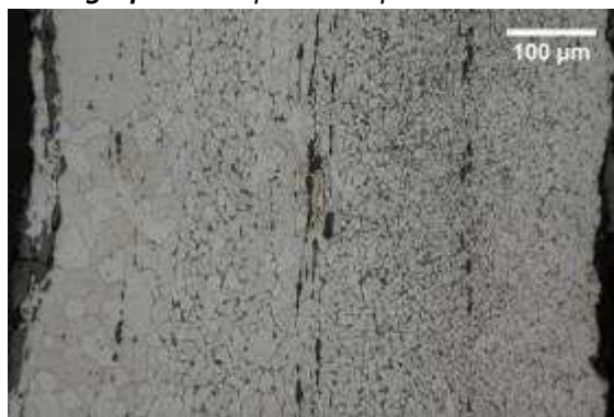
Micrographie 2 : Après attaque au Nital 3%
