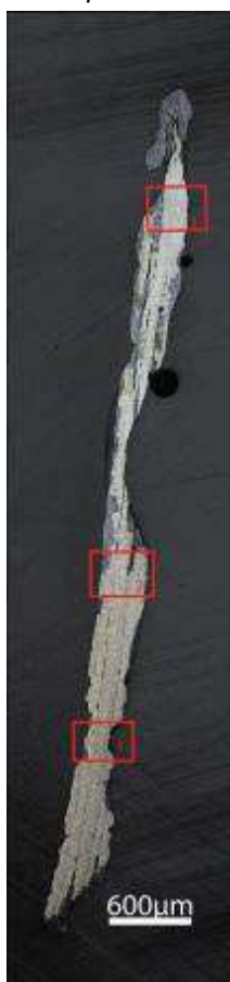
Mosaïque de l'échantillon (après attaque au Nital 3%)
