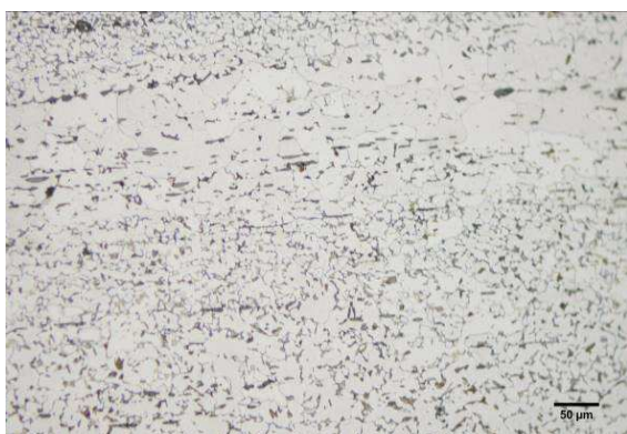
Micrographie 3 : Après attaque au Nital 3%
