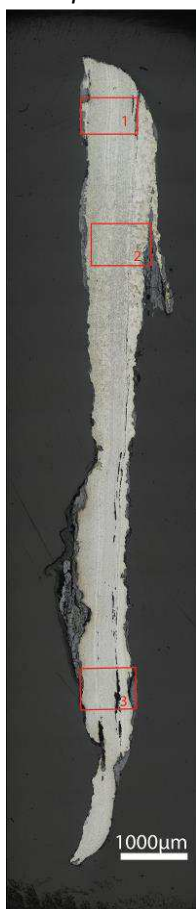
Mosaïque de l'échantillon (après attaque au Nital 3%)
