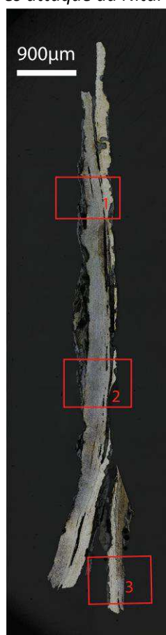
Mosaïque de l'échantillon (après attaque au Nital 3%)
