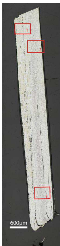
Mosaïque de l'échantillon (après attaque au Nital 3%)
