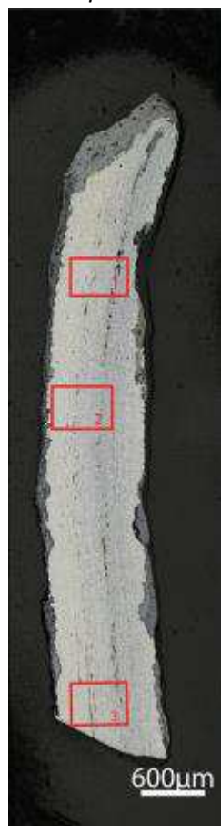
Mosaïque de l'échantillon (après attaque au Nital 3%)
