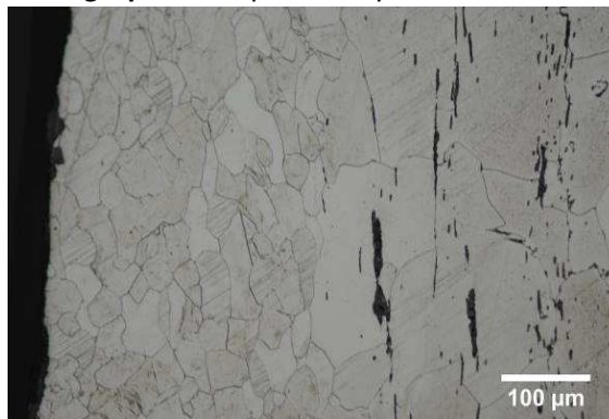
Micrographie 2 : Après attaque au Nital 3%
