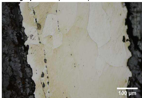
Micrographie 2 : Après attaque au Nital 3%
