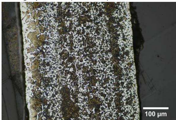
Micrographie 1 : Après attaque au Nital 3%
