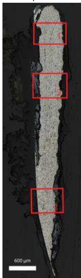
Mosaïque de l'échantillon (après attaque au Nital 3%)
