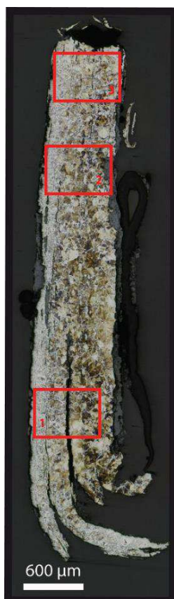
Mosaïque de l'échantillon (après attaque au Nital 3%)
