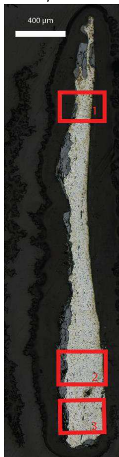
Mosaïque de l'échantillon (après attaque au Nital 3%)
