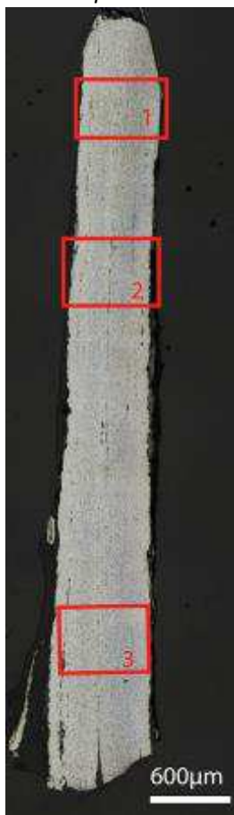
Mosaïque de l'échantillon (après attaque au Nital 3%)
