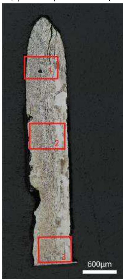
Mosaïque de l'échantillon (après attaque au Nital 3%)
