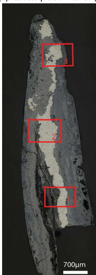
Mosaïque de l'échantillon (après attaque au Nital 3%)
