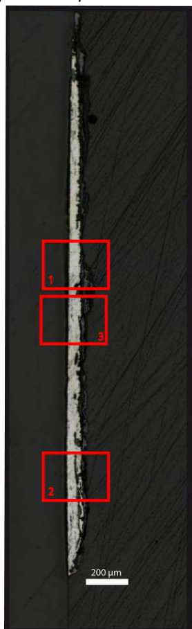
Mosaïque de l'échantillon (après attaque au Nital 3%)
