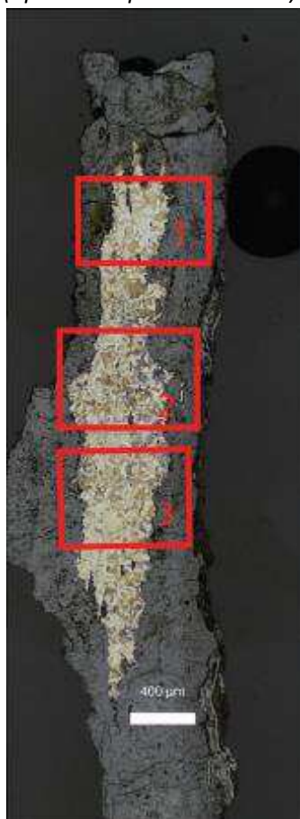
Mosaïque de l'échantillon (après attaque au Nital 3%)
