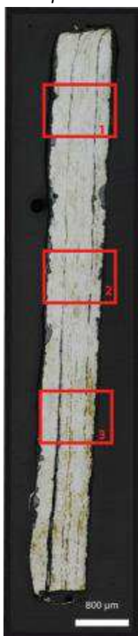
Mosaïque de l'échantillon (après attaque au Nital 3%)
