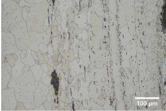
Micrographie 1 : Après attaque au Nital 3%
