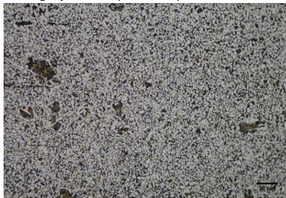
Micrographie 2 : Après attaque au Nital 3%
