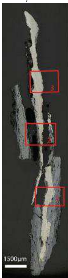
Mosaïque de l'échantillon (après attaque au Nital 3%)
