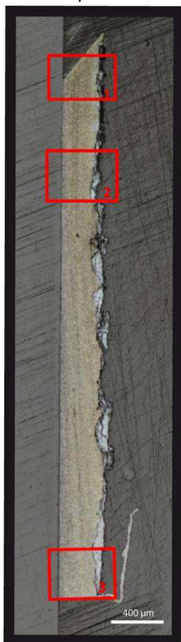
Mosaïque de l'échantillon (après attaque au Nital 3%)
