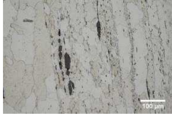
Micrographie 2 : Après attaque au Nital 3%
