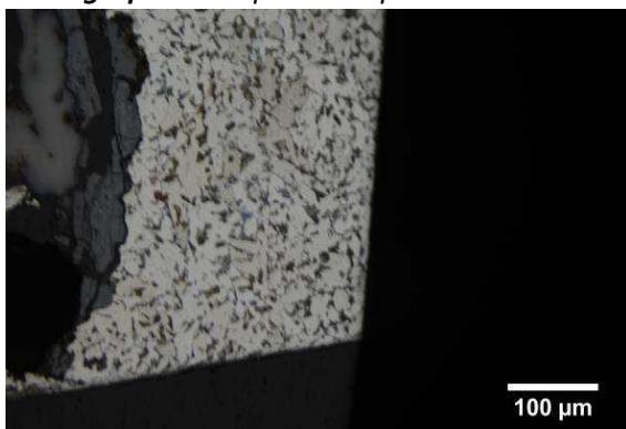
Micrographie 1 : Après attaque au Nital 3%
