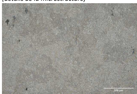
Micrographie 4 : Après attaque au Nital 3% (détails de la microstructure)
