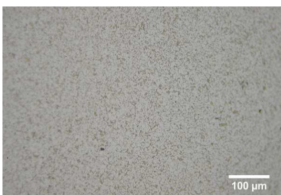
Micrographie 3 : Après attaque au Nital 3%
