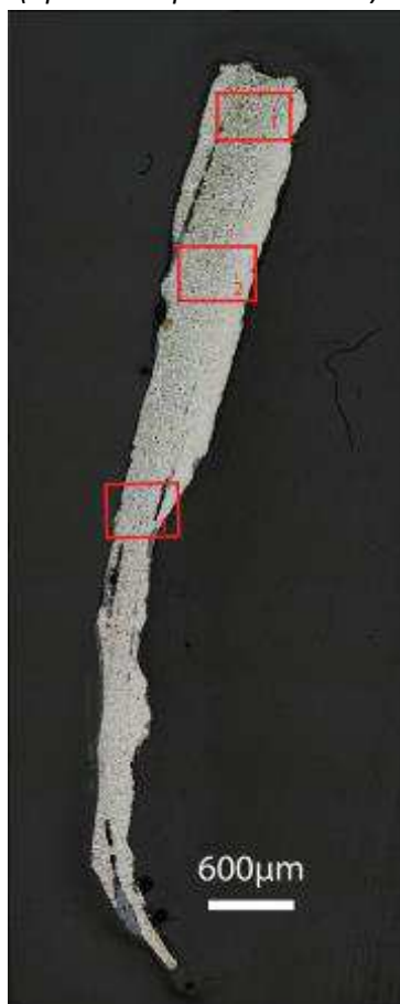
Mosaïque de l'échantillon (après attaque au Nital 3%)
