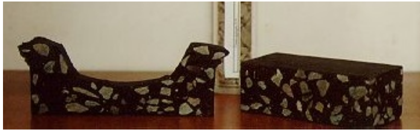
FIGURE 1.27: Coupes d'éprouvettes après et avant essai à l'orniéreur (base documentaire IFST-TAR/MAST/MIT)
