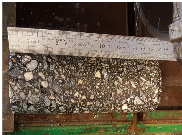
FIGURE 2.11: Sciage des extrémités d'une éprouvette carottée
