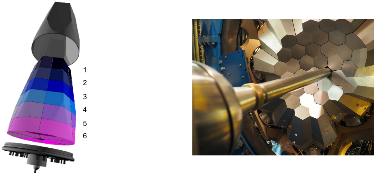
FIGURE 2.9 – À gauche : schéma 3D d'un détecteur d'AGATA avec les 36 segments. À droite, photo d'un détecteur AGATA prise dans la direction du faisceau lors de l'expérience AGATA-CHARADE.
