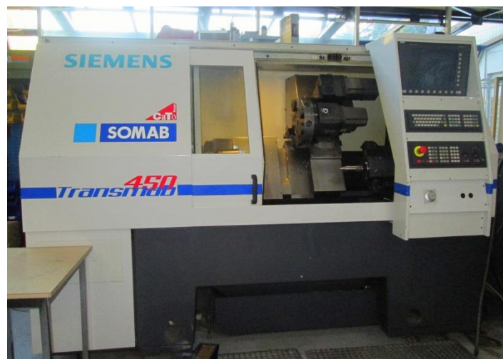
Figure 19 : Centre d'usinage TRANSMAB 450
