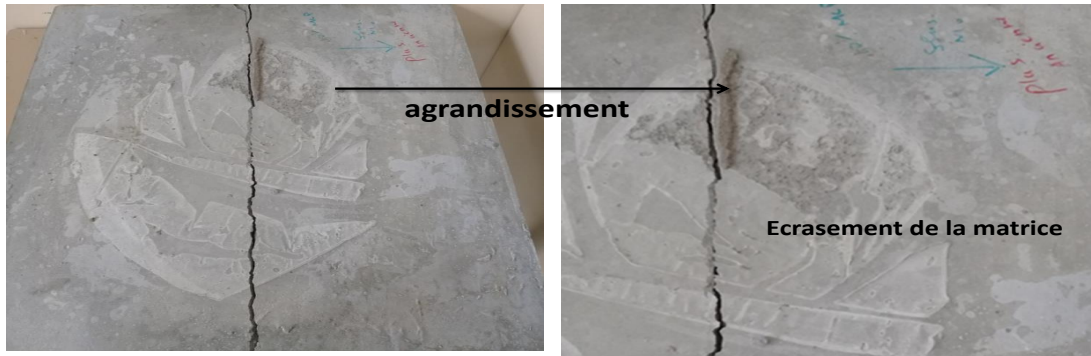
4 couches de renfort , rupture par écrasement de la matrice en face comprimée
