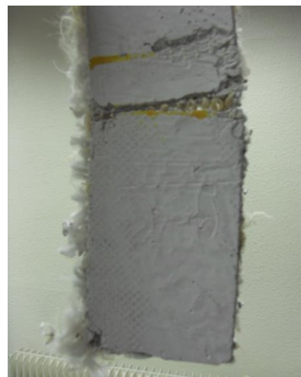
Occurrence d'un pull out (voisinage des mors)
