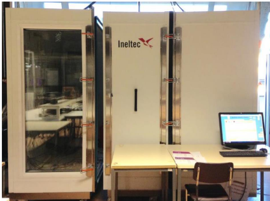
Figure III-6 Boite chaude gardée du laboratoire LTDS (ENTPE)
