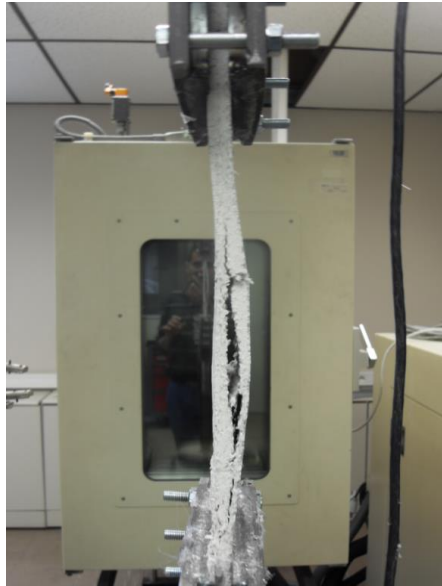
Rupture par délaminage entre couches du textile
