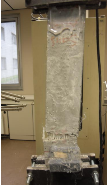
Rupture quasi simultanée des fils du textile en traction
