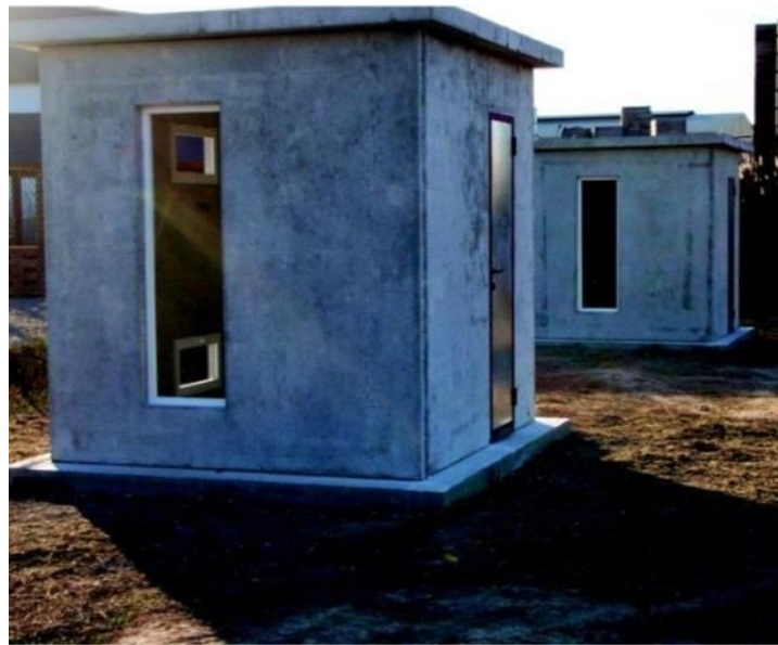
Figure I-18 Cellules de test réalisées par Castellon [37]
