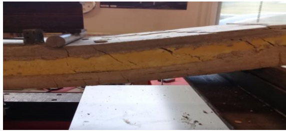
Rupture par cisaillement de l'ame du panneau 10% MCP-TRC
