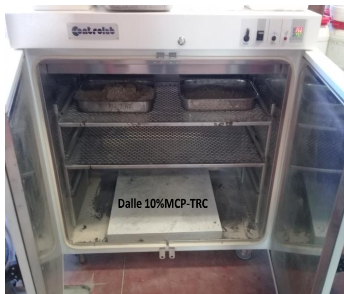
Figure IV-4 Chauffage des dalles 10% MCP-TRC en étuve
