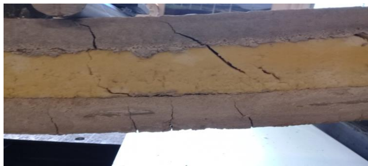
Analogie expérimentale (rupture par cisaillement de l'âme)
