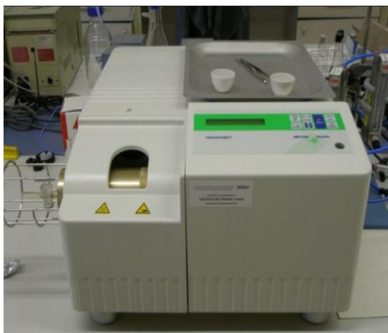
Figure II- 6 Analyse ATG sur dispositif Metler Toledo
