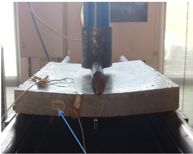
Une jauge sur l'axe neutre et située au \frac{1}{3} de la portée de la dalle
