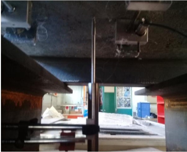
Un capteur LVDT pour mesurer la flèche à mi-portée
