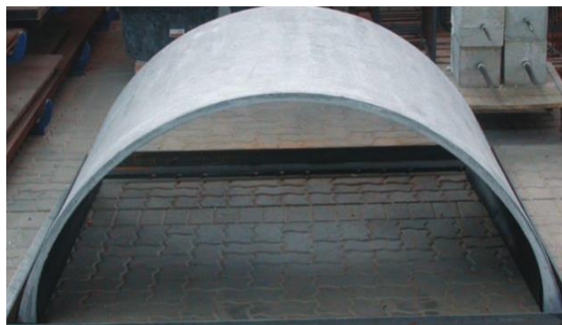
Figure I-42 Prototype de toit incurvé réalisé par [84]
