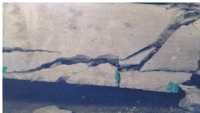
Rupture par délaminage dalles 10% MCP-TRC chauffées à 40°C
