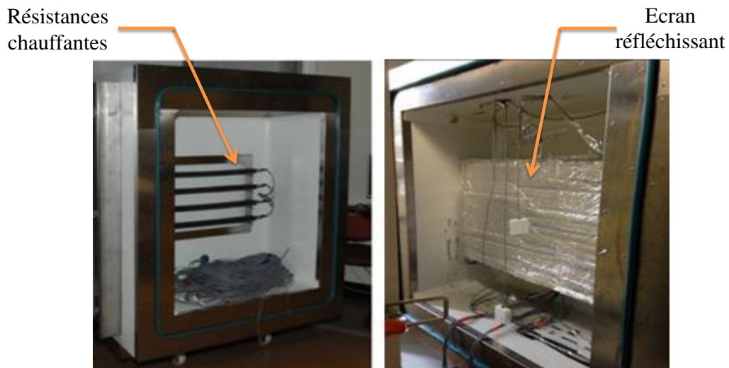
a- Equipement enceinte chaude
