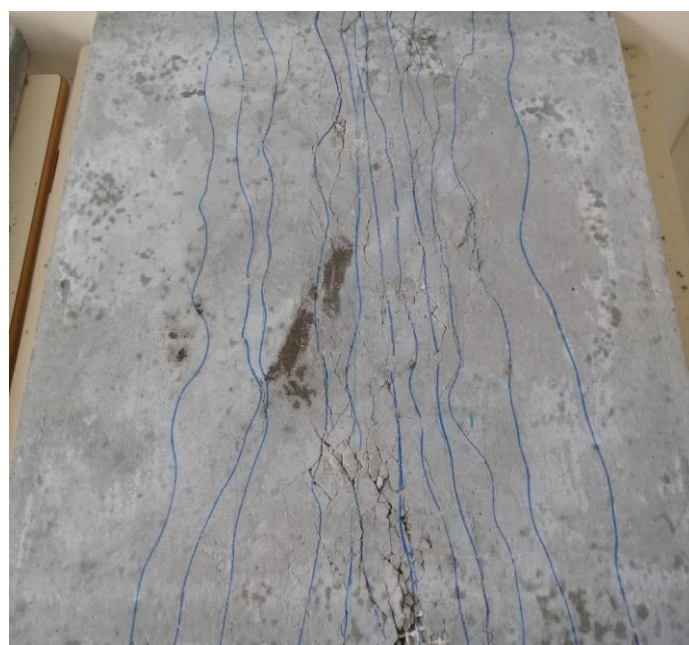
Dalle 10% MCP-TRC maintenue à 20°C
