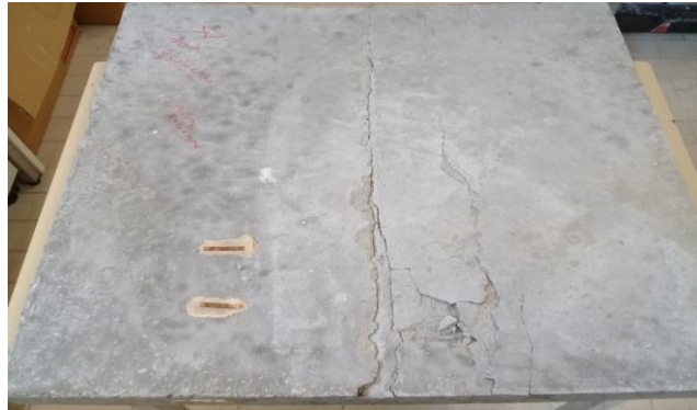
6 couches de renfort , rupture par écrasement de la matrice en face comprimée
