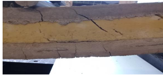
Rupture par cisaillement de l'ame du panneau 10% MCP-TRC
