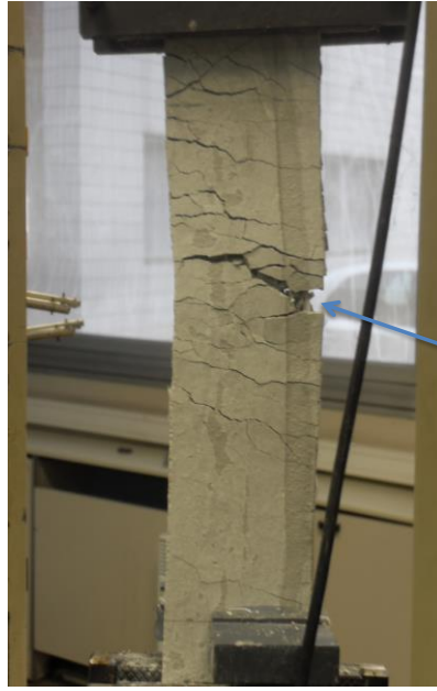
Rupture localisée sur quelques fils entraînant la rupture totale du textile en traction
