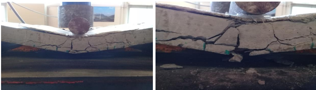
Rupture par écrasement dalles 10% MCP-TRC maintenues à 20°C
