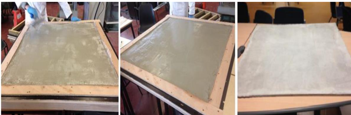
Plaques (1010×1010 ×10 mm) en MCP-TRC pour caractérisation thermique
