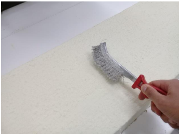
1-Ajustement de la rugosité de l'ame
