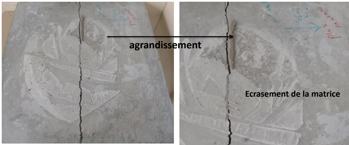
Rupture par écrasement dalles 10% MCP-TRC maintenues à 20°C
