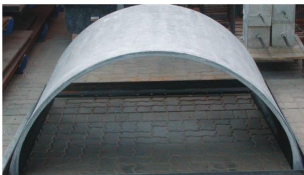
Figure I-42 Prototype de toit incurvé réalisé par [84]
