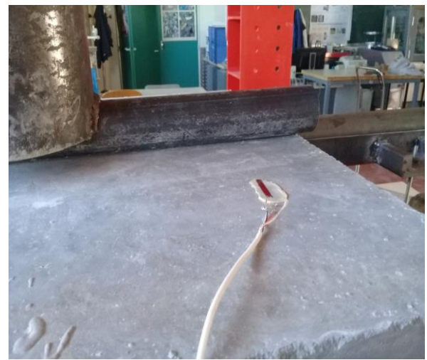
Une jauge sur la face comprimée située au \frac{1}{3} de la portée de la dalle
