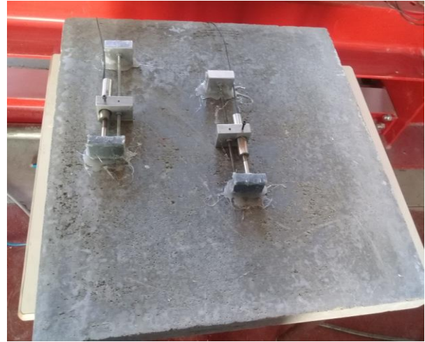
Deux capteur LVDT mesurant l'allongement en face tendue sur une longueur de mesure de 200 mm
