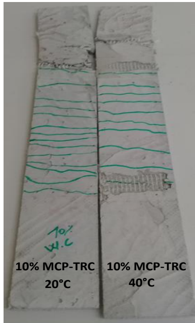
Figure III-27 Illustration effet de la température sur l'espace moyen entre fissures des composites 10% MCP-TRC.
