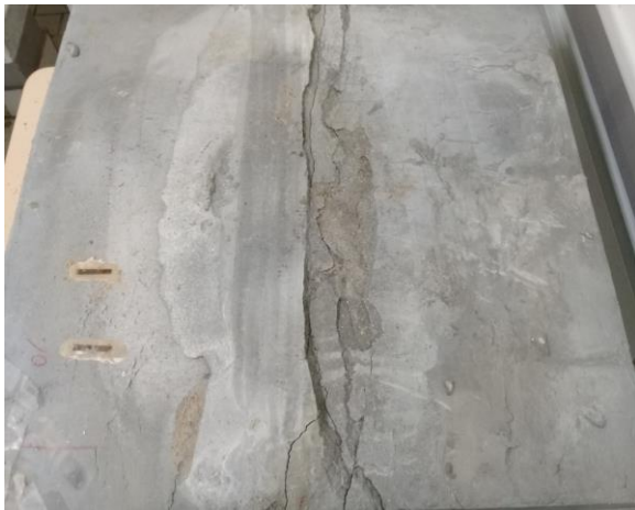
TRC de référence rupture par écrasement de la matrice
