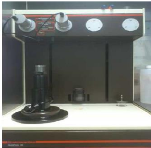
Figure II- 8 Dispositif utilisé lors des tests de porosimétrie par intrusion de mercure
