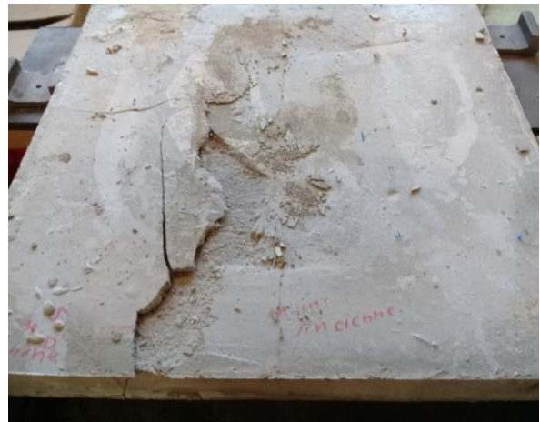
5% MCP-TRC rupture par écrasement de la matrice
