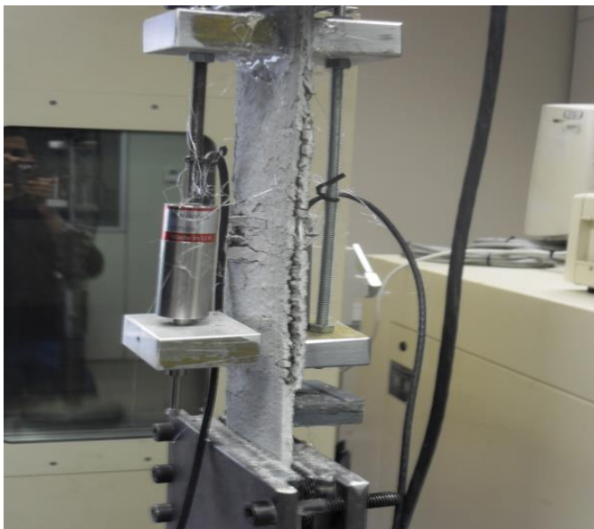
Rupture par délaminage
