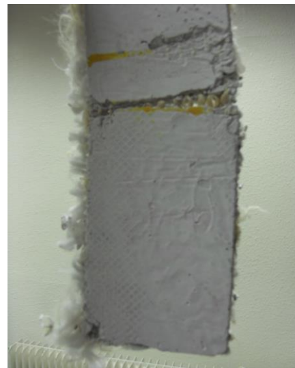
Occurrence d'un pull out (voisinage des mors)
