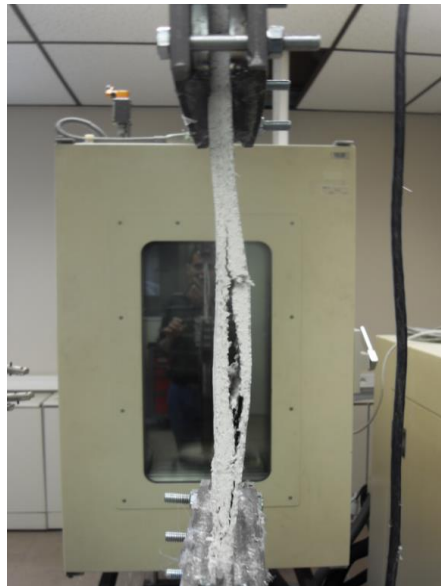
Rupture par délaminage entre couches du textile
