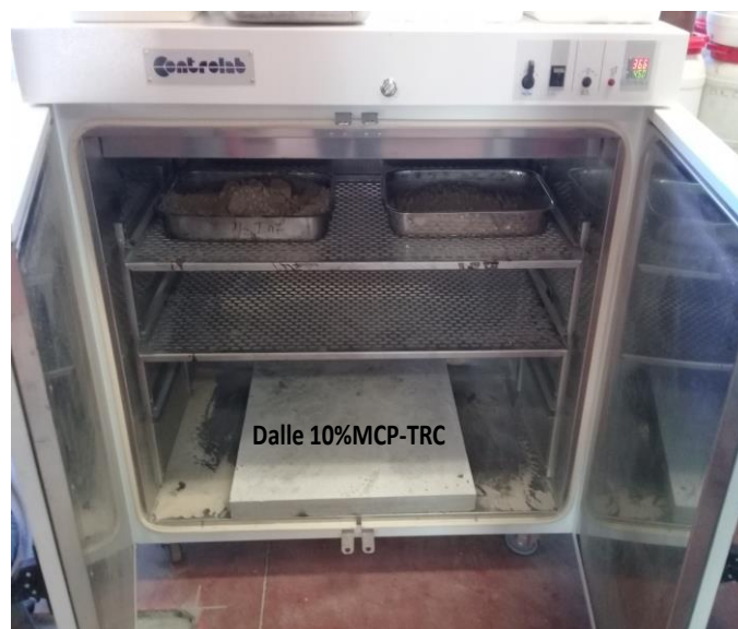
Figure IV-4 Chauffage des dalles 10% MCP-TRC en étuve
