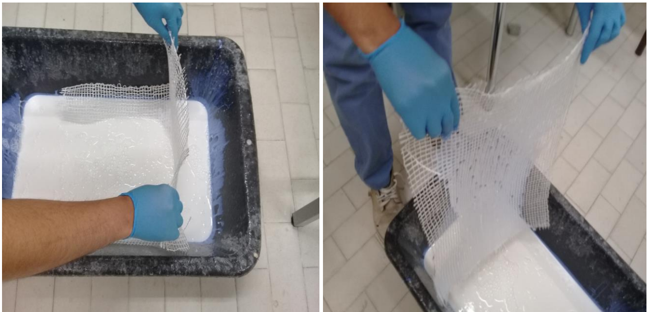
Figure III-5 Illustration de la pré-imprégnation Latex du renfort textile
