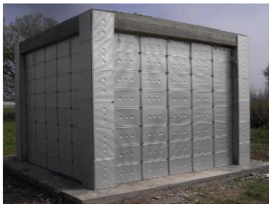
Cellule en brique alvéolaire + isolant +MCP
