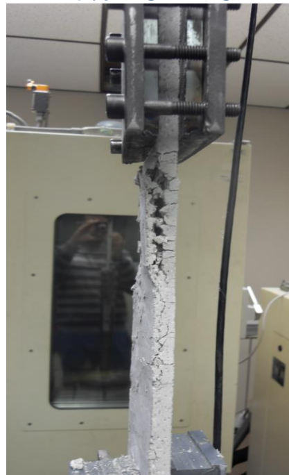
Rupture par délaminage entre couches du textile
