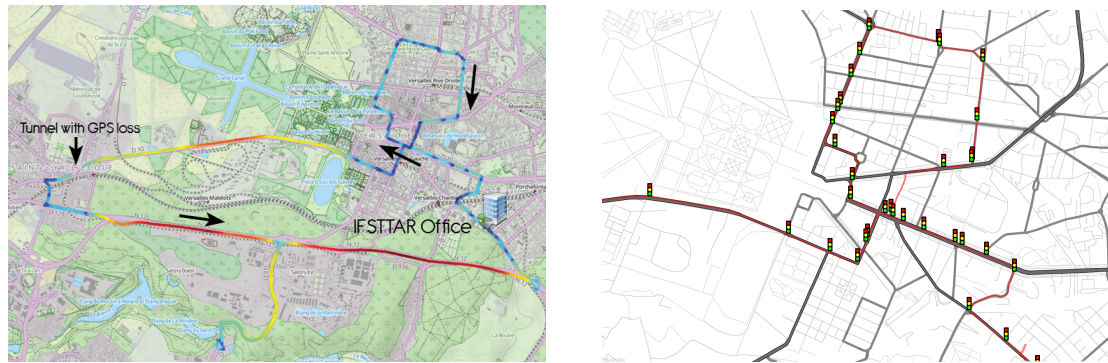
FIGURE 3.1 – À gauche : boucle de l'expérimentation. L'échelle des couleurs représente la vitesse moyenne des véhicules sur le parcours (du bleu vers le rouge à mesure que la vitesse augmente). À droite : positions des feux tricolores sur la partie urbaine du circuit.
