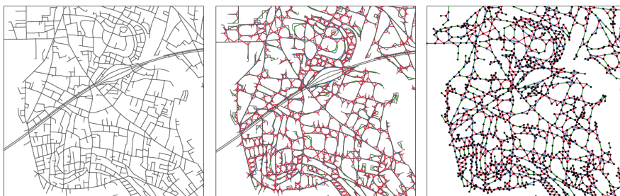
FIGURE 5.23 – Réseau routier (à gauche), construction du graphe adjoint (au centre) et graphe adjoint seul (à droite). le code couleur de la classification des arcs est identique à celui adopté sur les figures précédentes 5.21 et 5.22.
