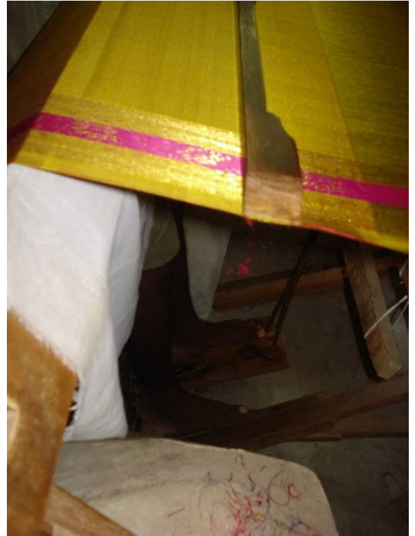
Figure 14: Le métier à tisser à fosse utilisé par les tisserands de Kanchipuram (photo de l'auteur)
