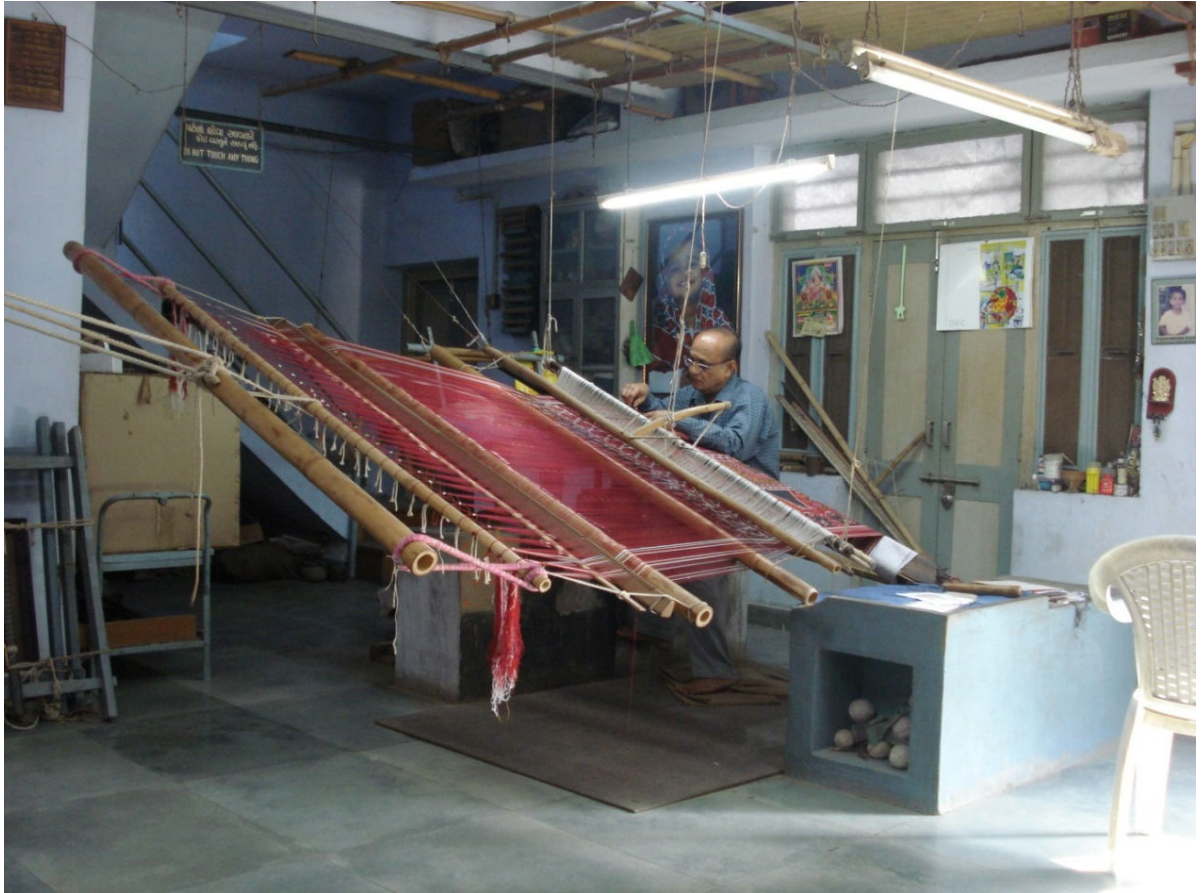
Figure 15: Le métier à tisser patola (photo de l'auteur) Le métier à tisser horizontal avec une inclinaison, suspendu par des cordes à la poutre. Cette inclinaison permet au tisserand de travailler seul au besoin.
