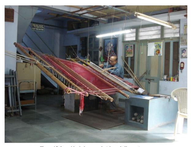
Figure 15: Le métier à tisser patola (photo de l'auteur) Le métier à tisser horizontal avec une inclinaison, suspendu par des cordes à la poutre. Cette inclinaison permet au tisserand de travailler seul au besoin.
