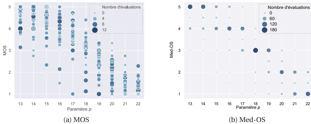
FIGURE 6.16 – Distribution des valeurs moyennes (MOS) et médianes (Med-OS) des scores d'opinions pour chaque objet 3D chiffré en fonction du paramètre p .
