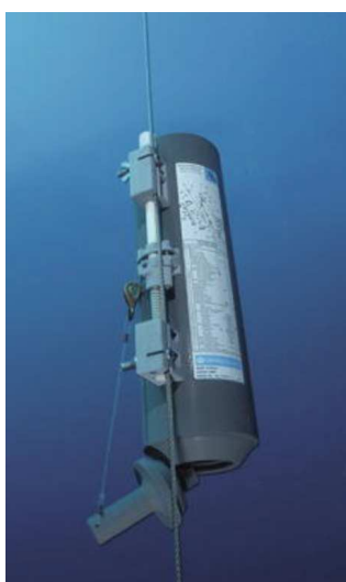
Figure 27. Bouteille Niskin permettant de prélever de l'eau à une profondeur choisie.
