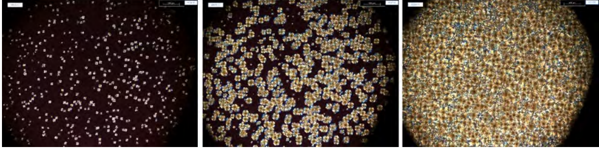
FIGURE 2.4 – Micrographies optiques de la croissance des sphérolites du PEKK
