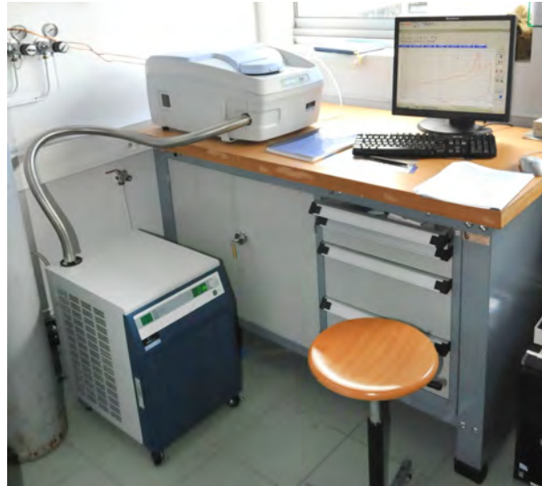
FIGURE 2.26 – Système d'analyse calorimétrique différentielle (ICA Albi)
