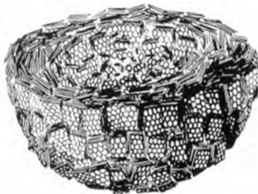
FIGURE 1.12 – Vue en coupe d'une particule de noir de carbone [Hassar, 2013]
