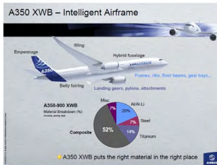
FIGURE 1.2 – Composition de l'Airbus A350 ©Airbus
