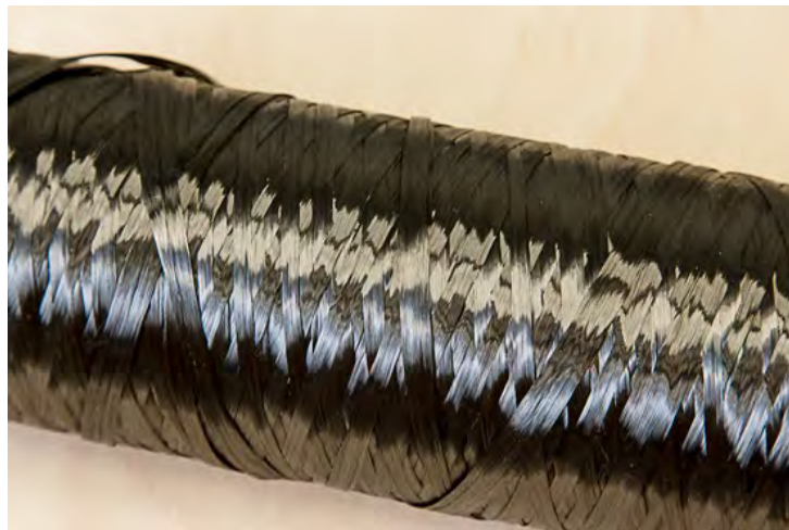
FIGURE 1.8 – Bobine de pré-imprégné produit sur la ligne d'imprégnation de l'IRT
