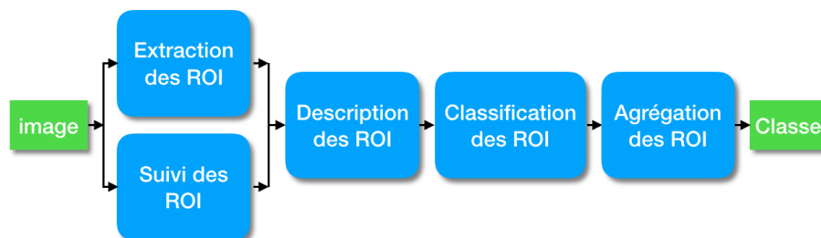
FIGURE 4.5 : Chaîne de traitement pour l'extraction et suivi des ROI pour la détection automatique des polypes.
