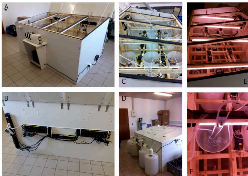
Figure II-3 Dispositif expérimental en mésocosmes. A : Vue de devant du mésocosme ouvert. B : Vue arrière du mésocosme. C : Vue du mésocosme ouvert avec les bidons de 25 litres. D : Vue de devant du mésocosme fermé avec les 4 bidons d'alimentation de 50 litres. E : Vue ouverte du mésocosme avec les néons éclairés. F : Vue ouverte du mésocosme avec un zoom sur un bidon d'alimentation et un néon éclairé.
