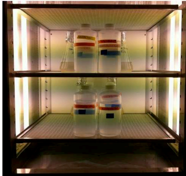
Figure II-2 Microcosme installé en laboratoire dans une chambre de culture.
