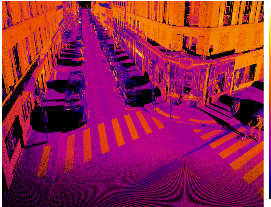
FIGURE 1.8: Exemple de données acquises par un laser plan de type RIEGL VQ-250 (réflectance de -20dB=noir à 0db=blanc)
