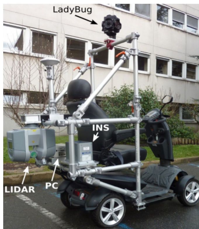
FIGURE B.1: Véhicule de cartographie mobile terrestre Viapolis adapté à la circulation sur le trottoir ou dans les espaces difficiles d'accès pour le véhicule Stéréopolis.
