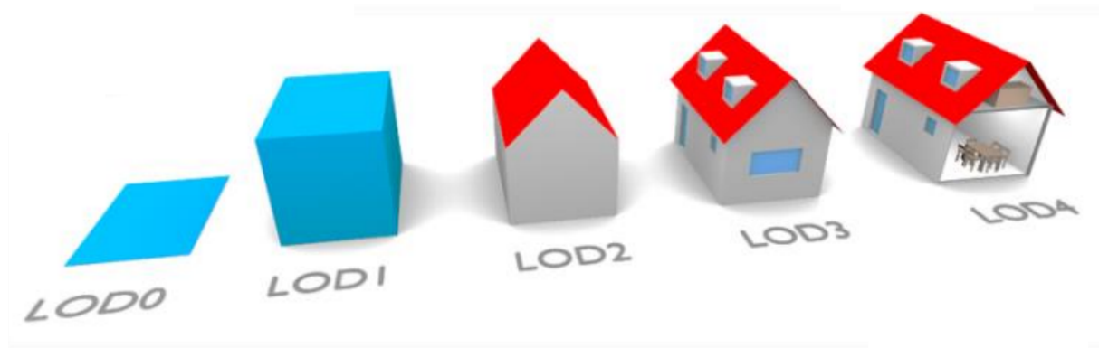
FIGURE 1.4: Les différents niveaux de détails du modèle 3D de bâtiments (Level Of Details =LOD)
