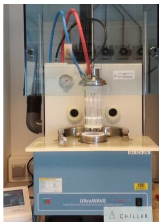
Figure 19 : Micro-ondes (type « fermé ») utilisé pour l'extraction des espèces d'arsenic des phases réceptrices ferrihydrite (Ultra Wave, Milestone)
