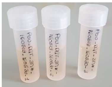
Figure 16 : Tubes à élution de 5 mL en PP annoté et contenant une phase réceptrice 3M
