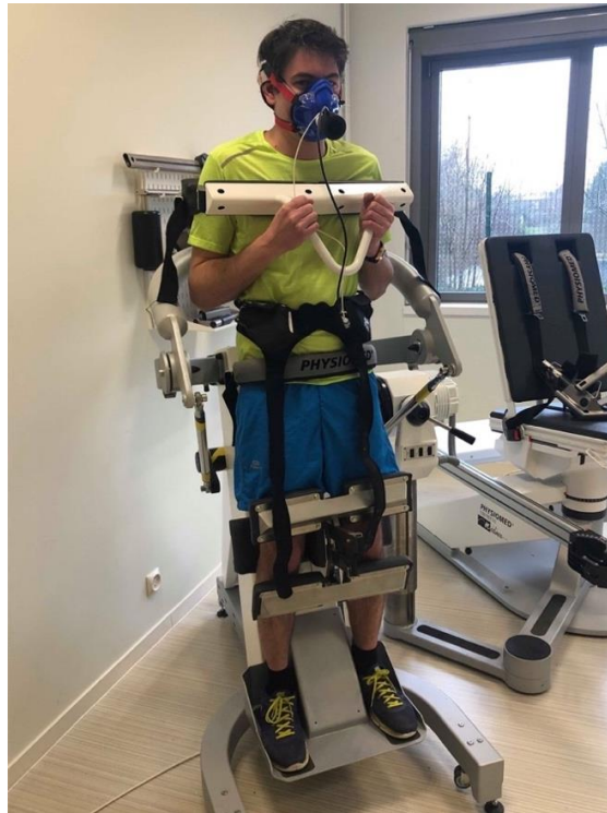
Figure 27 Participant installé sur un dynamomètre isocinétique, équipé de l'analyseur d'échanges gazeux pulmonaires.
