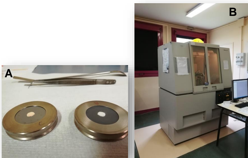
Figure II- 5:A : support contenant l'échantillon, B : Appareil Panalytical utilisé
