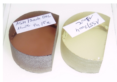
FIGURE 5.28 – Blocs de verre dont ont été extrait les verres modèles synthétisés par Marie-Hélène Chopinet (Unité mixte CNRS/Saint-Gobain). Ces verres ont une composition de verre float , dopés avec un mélange fer/manganèse. On peut remarquer la similarité dans la couleur du bloc de gauche avec le verre sodique de la figure 5.27
