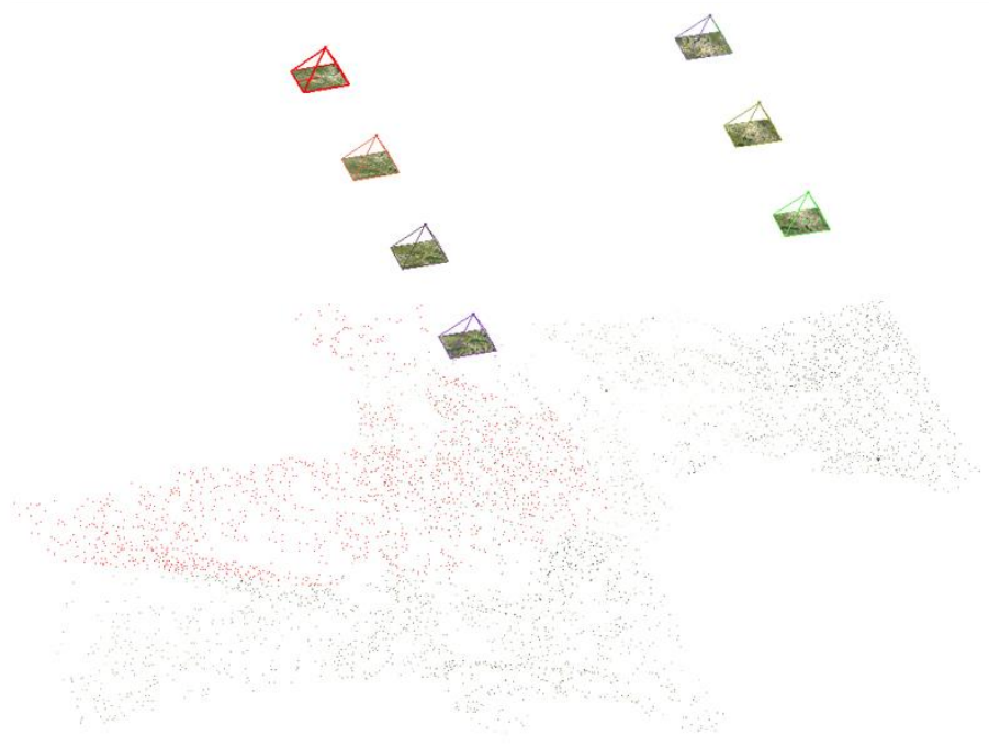
Figure 55. Triangulation 3D des photographies aériennes et création du nuage de points – capture d'écran VisualSFM
