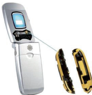
Figure 179 : Exemple d'une antenne sur la coque d'un téléphone.
