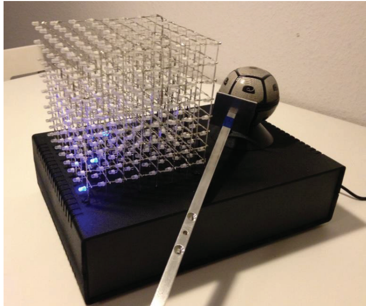
Figure 212 : Capteur de proximité 3D en plastronique.
