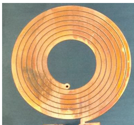
Figure 86 : Inductance plastronique 2D de numéro i13+ fabriquée par structuration laser et épaissie avec 20 \mu\text{m} par électrodéposition.
