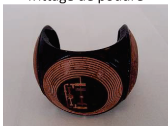
Dépôt autocatalytique de cuivre
