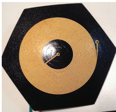
Figure 207 : Inductance i29 sur une calotte sphérique à frontière hexagonale.
