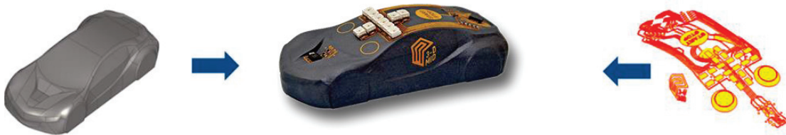
Figure 1 : Exemple d'un système plastronique 3D (centre) issu de l'association d'un support plastique (à gauche) et d'un circuit électronique (à droite) [1].
