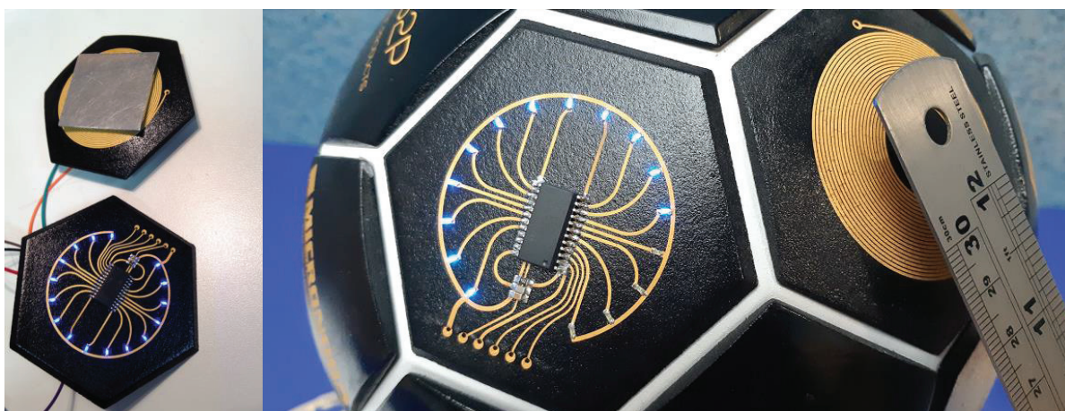
Figure 208 : Capteur de proximité en plastronique 3D sur un démonstrateur de salon en forme de ballon.
