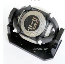
Pièce après étamage à froid et mise sur un posage
