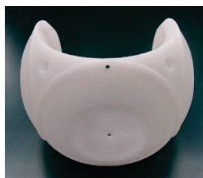
Pièce fabriquée par frittage de poudre
