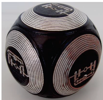
Figure 90: Sphère plastronique réalisée par structuration laser, électrodéposition de cuivre et étamage
