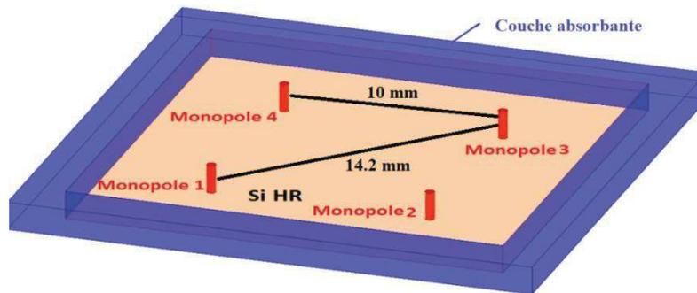
Figure 4-9: Rappel du scénario avec 4 monopoles
