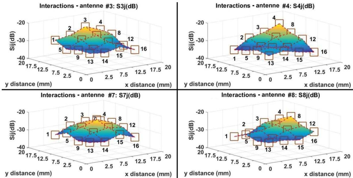
Figure 3-59: Cartes d'atténuation des antennes 3,4, 7 et 8
