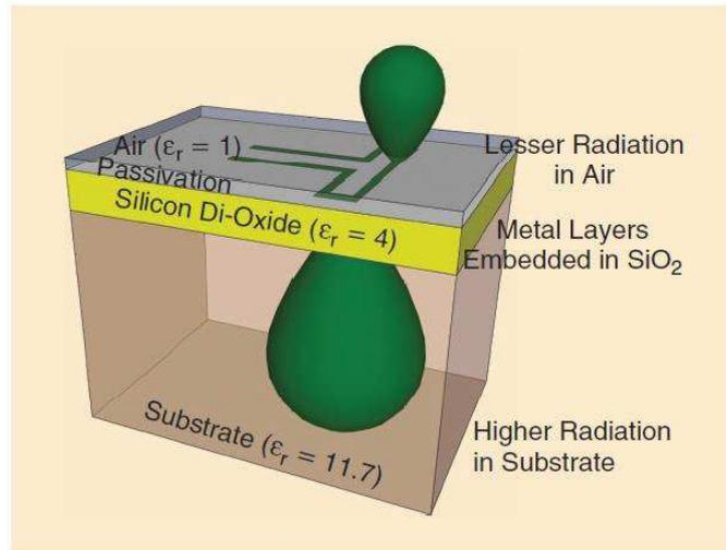
Figure 1-27: Rayonnement des antennes intégrées dans le substrat [90]
