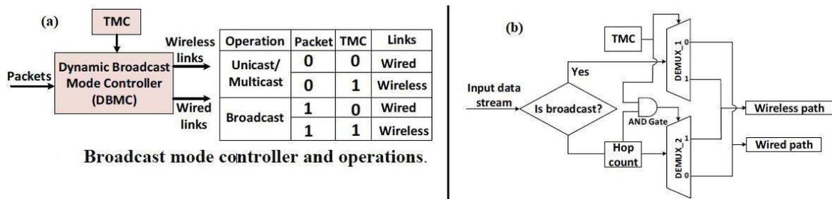
Figure 4-22: (a) Opérations et (b) circuit du DBMC [188]
