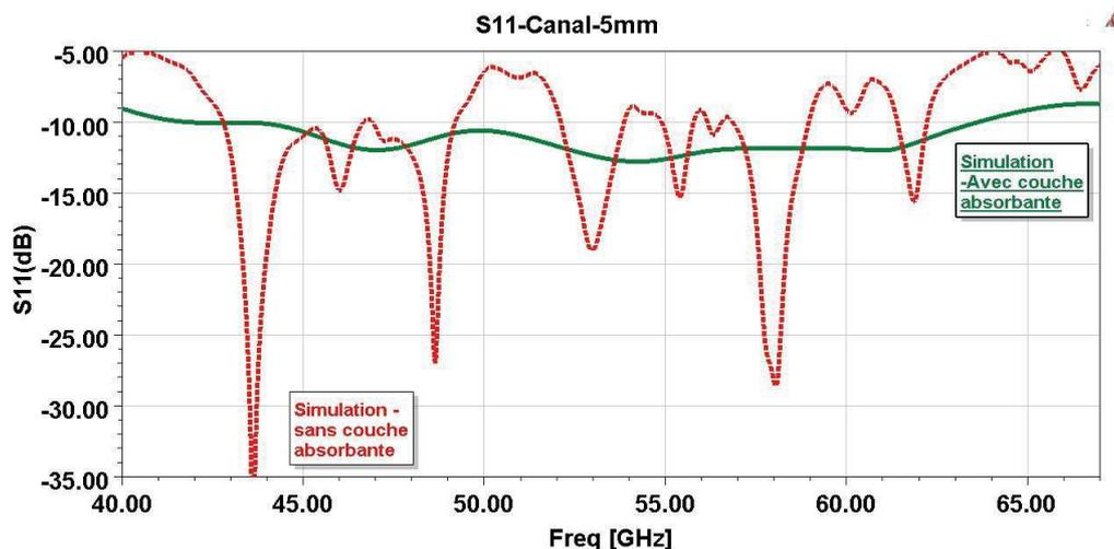
Figure 3-11: Comparaison des paramètres  $S_{11}$  du dipôle
