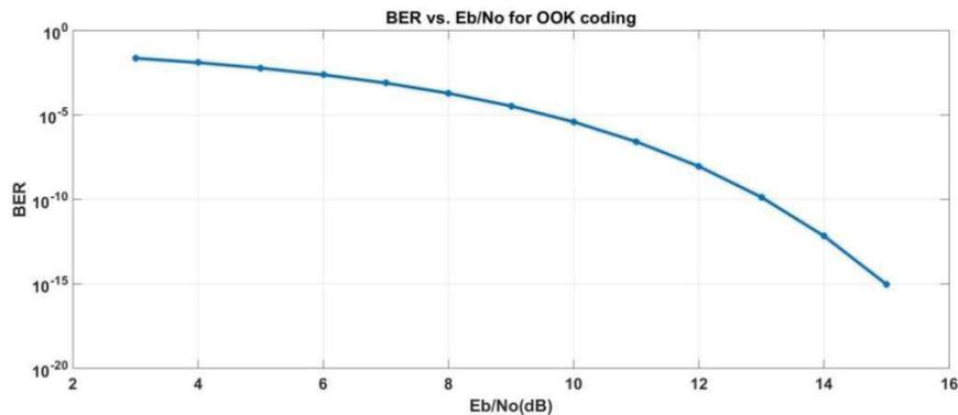
Figure 4-1: BER vs.  $E_b/N_o$  pour une modulation OOK
