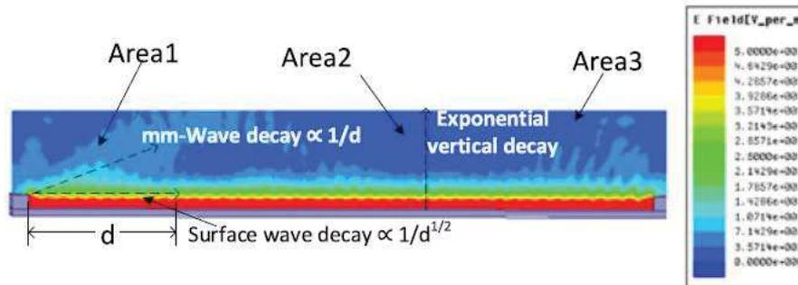
Figure 1-11: Une simulation d'un système de communication par ondes de surface [36]
