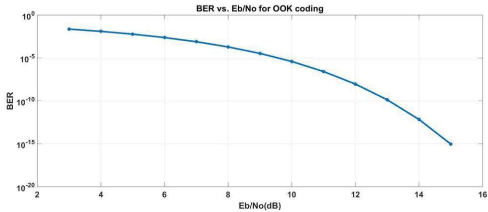
Figure 1-20: BER vs.  $E_b/N_o$  pour une modulation OOK
