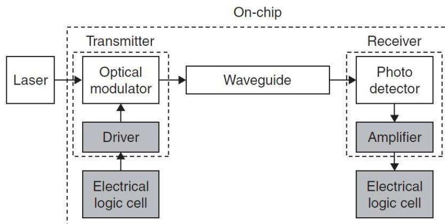
Figure 1-7: Schéma fonctionnel d'une interconnexion optique [10]
