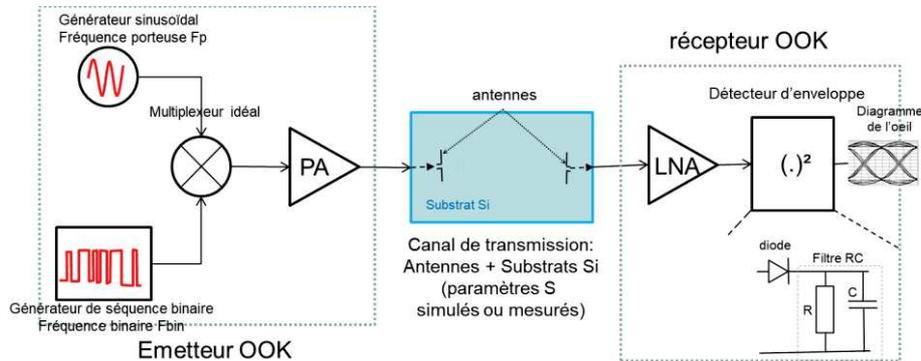
Figure 4-2: schéma fonctionnel d'une chaîne de transmission WiNoC
