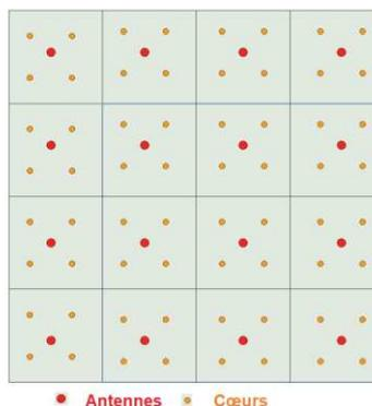
Figure 1-45: Une topologie maillée avec 16 antennes et 64 cœurs
