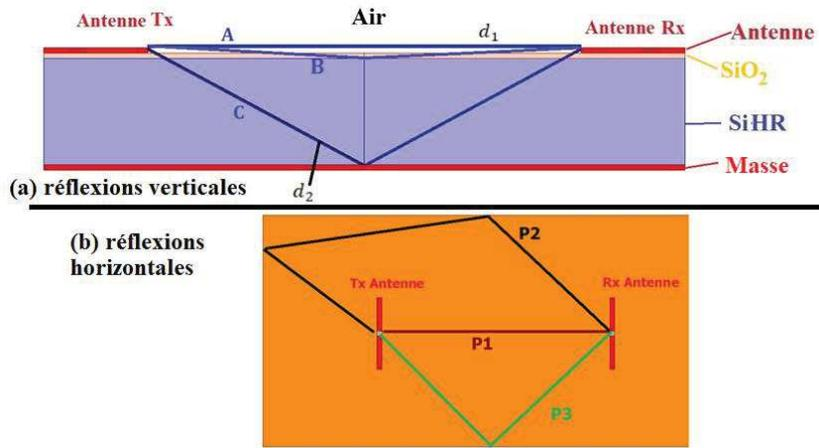
Figure 1-39: Exemple typique des réflexions verticales et horizontales
