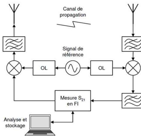
Figure 1-33: Passage du domaine fréquentiel au domaine temporel [136]
