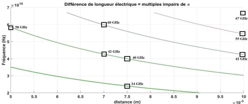
Figure 2-43: Localisation des possibles zéros de transmission
