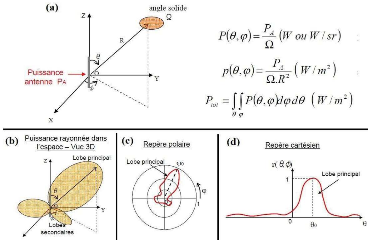
Figure 1-23: (a) Puissance rayonnée par une antenne dans une direction de l'espace ; Représentation du diagramme de rayonnement d'une antenne : (b) en 3D ; (c) polaire ; (d) cartésienne [89]
