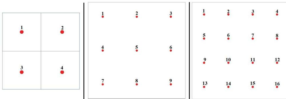
Figure 3-46: Scénarios à 4,9 ou 16 antennes
