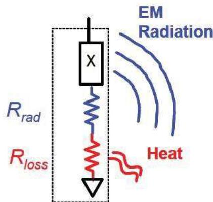
Figure 1-28: Modèle électrique équivalent de l'antenne [120]
