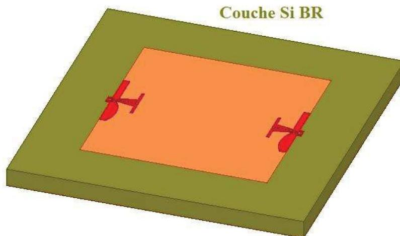
Figure 3-10: Canal entre 2 dipôles simulés dans la bande V avec la couche absorbante
