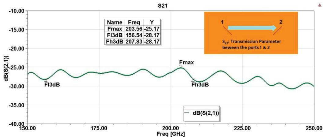
Figure 1-37: Transmission idéale entre deux antennes  $S_{21}$
