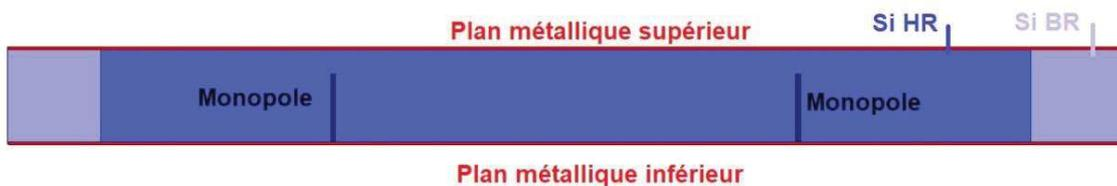
Figure 3-51: Structure avec un plan métallique supérieur
