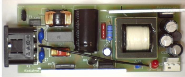
FIGURE 2.22 – Alimentation conçue et fabriquée pour la thèse, appelée « DPS »
