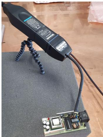
FIGURE 3.8 – Sonde différentielle de tension IsoVu TIVH05L de la marque Tektronix
