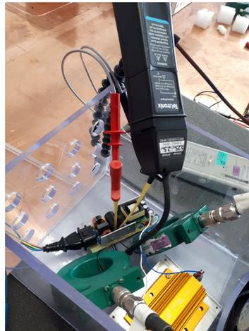
FIGURE 3.30 – Exemple d'une configuration de mesures de signaux électriques autour du pont de diodes
