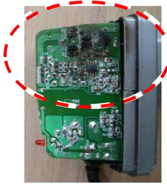
FIGURE 1.11 – Exemple de destruction d’une alimentation due à un courant impulsionnel important résultant du couplage d’une IEMN-HA sur une ligne aérienne de distribution en électricité
