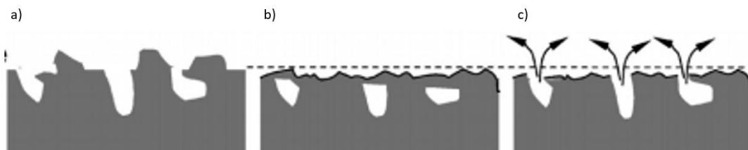
Figure 7 Réouverture des porosités fermées après polissage, lors du chauffage sous vide de substrat graphite (Sobczak et al., 2005), a) état brut – porosité ouverte, b) après polissage – porosité fermée, c) chauffage sous vide – porosité ouverte
