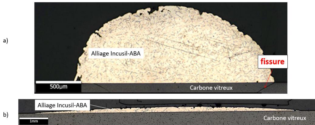
Figure 180 Images au microscope optique des coupes transversales des échantillons Incusil-ABA/carbone vitreux a) 750°C/5min et b) 920°C/5min
