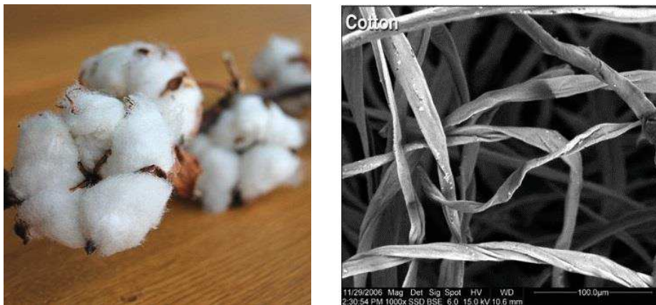
Figure 1-2 : A gauche – Fleur de cotonnier, A droite – Image MEB de fibres de coton 18
