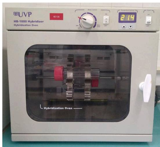
Figure 3-2. Four d'hybridation UVP HB-1000 utilisé dans ce travail (laboratoire MAPIEM, Université de Toulon)
