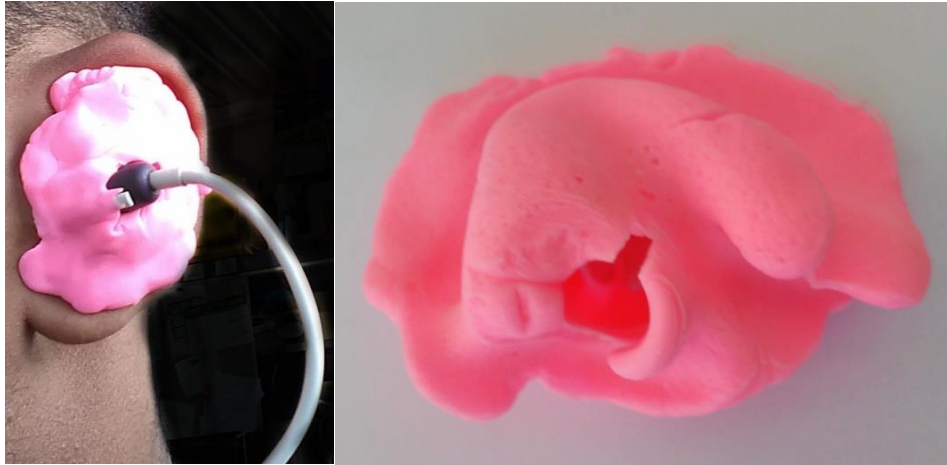
Figure 3-8 - Exemple du moule réalisé pour fixer la sonde (source : Jeferson Da Silva)
