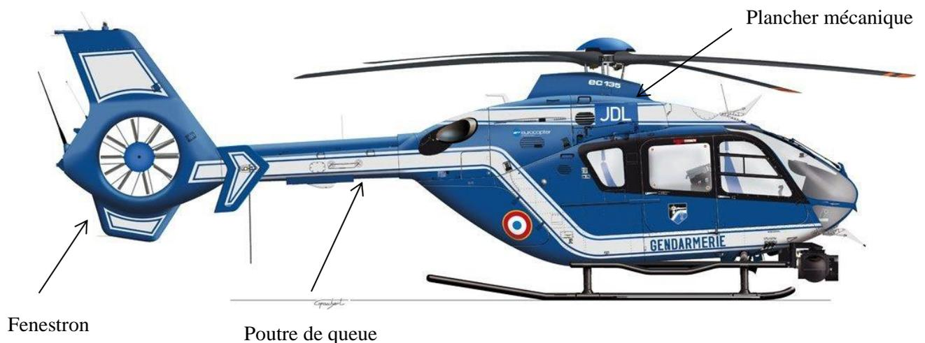
**Figure 12** : Parties techniques de l'hélicoptère H135 de Airbus Helicopters sur lesquelles huit zones ont été observées et étudiées. Nos documents techniques faisant ressortir toutes les caractéristiques des analyses de maintenabilité.
