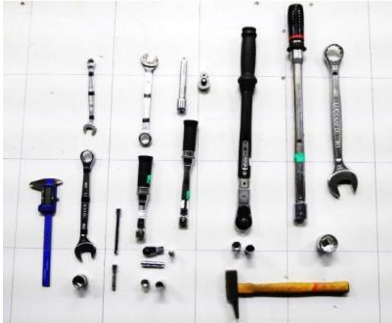
**Figure 32 :** Ensemble des outillages de maintenance mis à disposition des opérateurs pour réaliser chacune des 11 tâches de maintenance.
