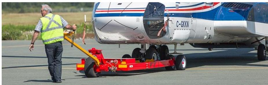
**Figure 9** : Outillage appelé barre de tractage motorisée afin d'aider l'opérateur de maintenance à déplacer plus facilement l'hélicoptère au sol.
