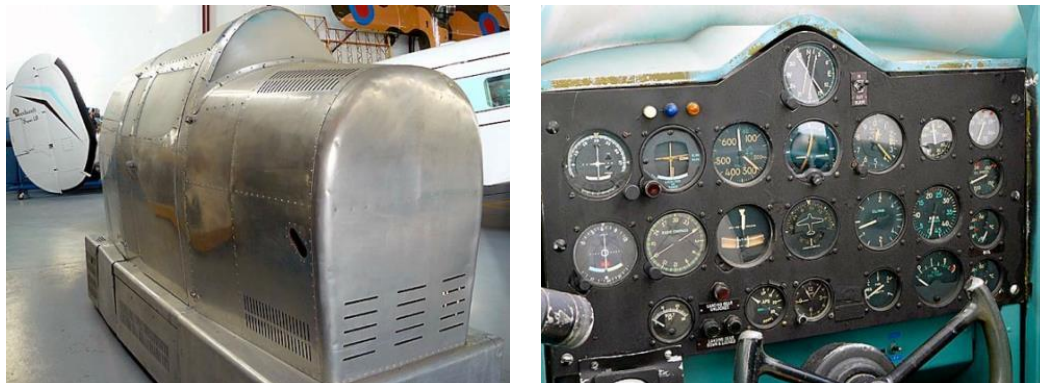
Figure 24 : Simulateur statique intégrant les premiers effets d'immersion visuelle et sonore, construit par Curtiss-Wright Corporation.
