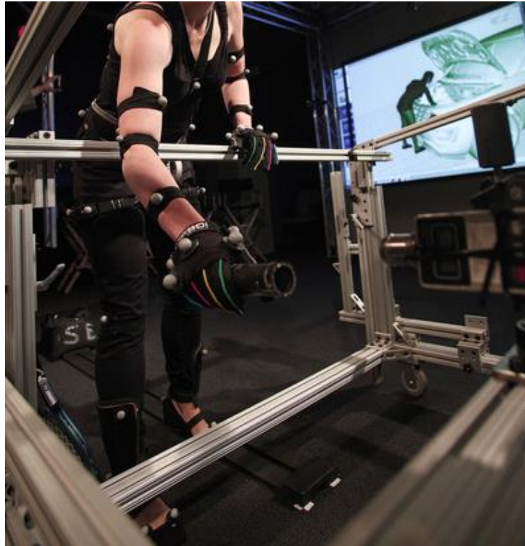
Figure 27 : Table modulaire utilisée sur une plateforme de réalité virtuelle et synchronisée avec le monde virtuel par le constructeur automobile Ford sur le site Dearborn (2016).
