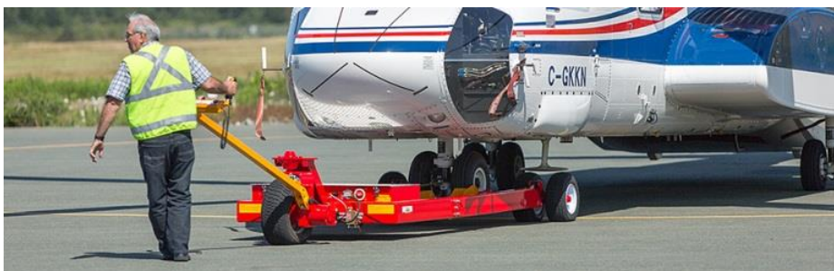
Figure 9 : Outillage appelé barre de tractage motorisée afin d'aider l'opérateur de maintenance à déplacer plus facilement l'hélicoptère au sol.
