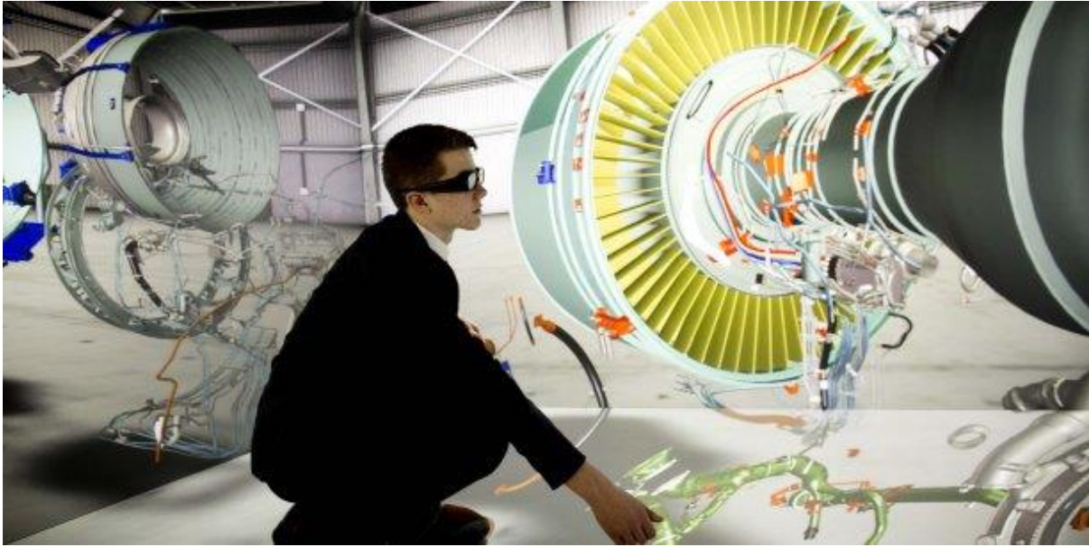
Figure 21 : Ingénieur immergé dans un environnement 3D afin d'étudier l'accessibilité des pièces d'un moteur d'avion afin d'assurer la maintenance future.
