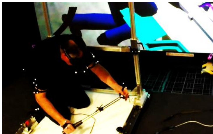
Figure 39 : Usage d'une clé dynamométrique réelle sur la plateforme de réalité virtuelle.
