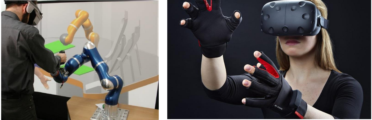
Figure 25 : Système de bras haptiques synchronisés ( gauche ) et système de gants haptiques simulant l'action de préhension d'objets ( droite ).
