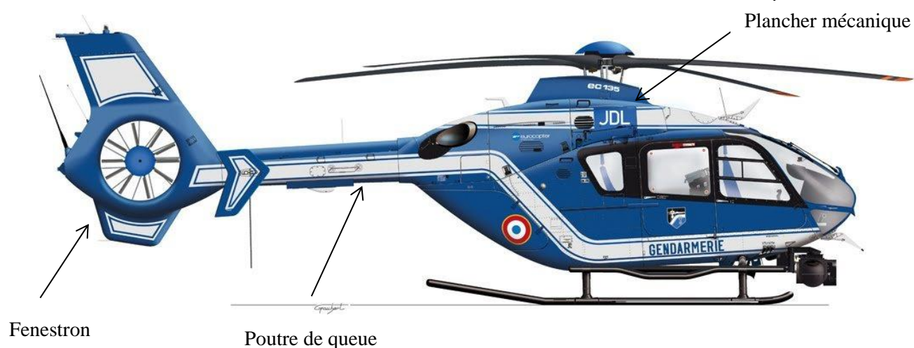
Figure 12 : Parties techniques de l'hélicoptère H135 de Airbus Helicopters sur lesquelles huit zones ont été observées et étudiées. Nos documents techniques faisant ressortir toutes les caractéristiques des analyses de maintenabilité.
