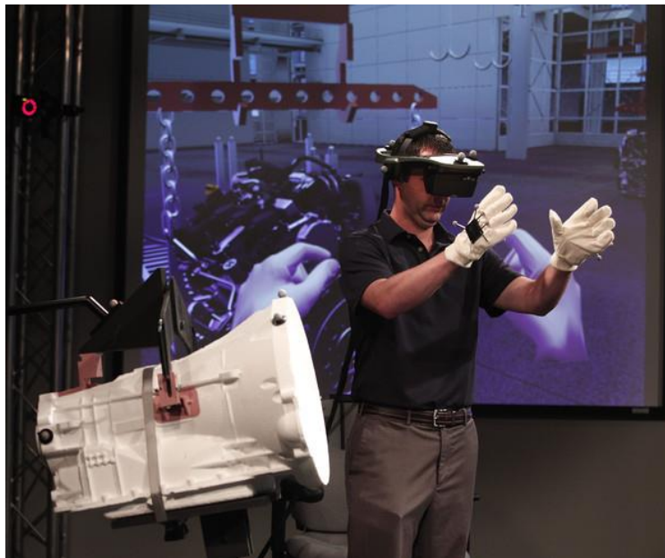
Figure 26 : Pièce de moteur de voiture en impression 3D dédiée à une plateforme de réalité virtuelle par le constructeur automobile Ford sur le site Dearborn (2016).
