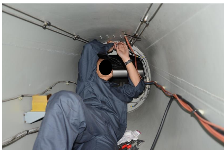
Figure 48 : Maintenance effectuée dans la poutre de queue d’un hélicoptère.
