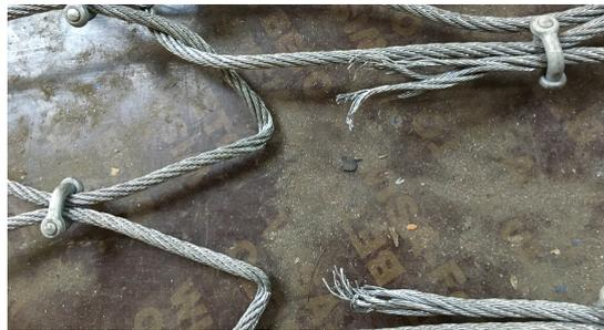
FIGURE 4.11 – Vue du câble central après rupture lors d'un essai de traction dans le plan sur deux rangées de mailles
