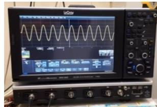
Fig. 22. Lecroy Waverunner oscilloscope.
