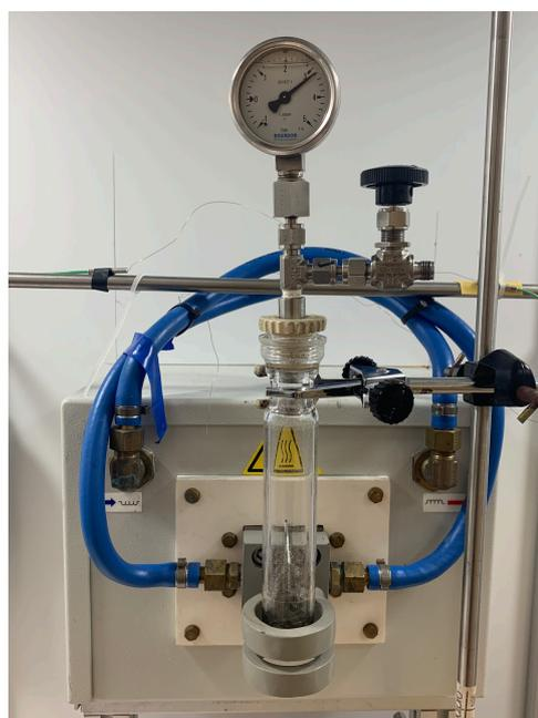
Figure 1: Bouteille Fischer-Porter surmontée d'un manomètre, placée au centre d'une bobine.
