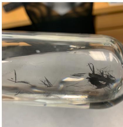
**Figure 13: Chaines de nanoparticules de Fe<sub>30</sub>Ni<sub>70</sub>@Ni après catalyse sous champ magnétique.**
