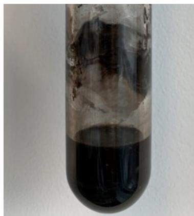
Figure 3: Bouteille Fischer-Porter après catalyse de la réaction d'HDO de l'acétophénone. Les nanoparticules sont en partie sur les parois de la bouteille.
