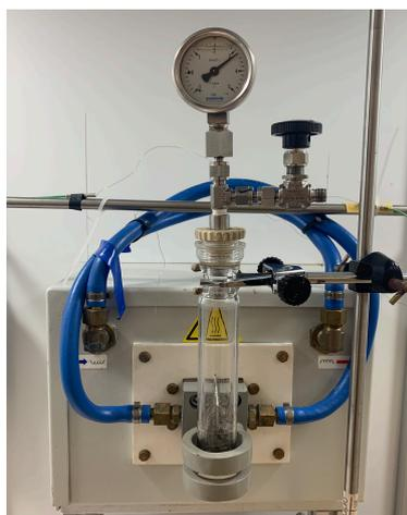
**Figure 21: Bouteille Fischer-Porter surmontée d'un manomètre et placée au centre d'une bobine.**
