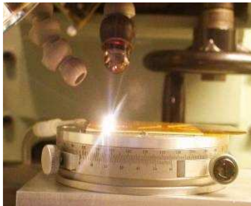
Figure IV.42. Photo de l'instant précis de l'ablation laser d'un échantillon
