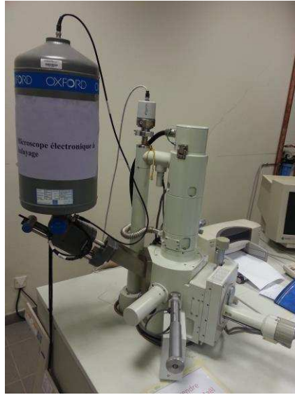
Figure A2.1. Microscope Electronique à Balayage JEOL JSM 5600 localisé à l'IUT de Saint Briec
