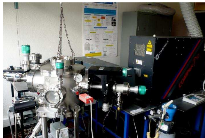
Figure III.2. Bâti d'ablation laser pulsé en place à l'ISCR - Université de Rennes 1
