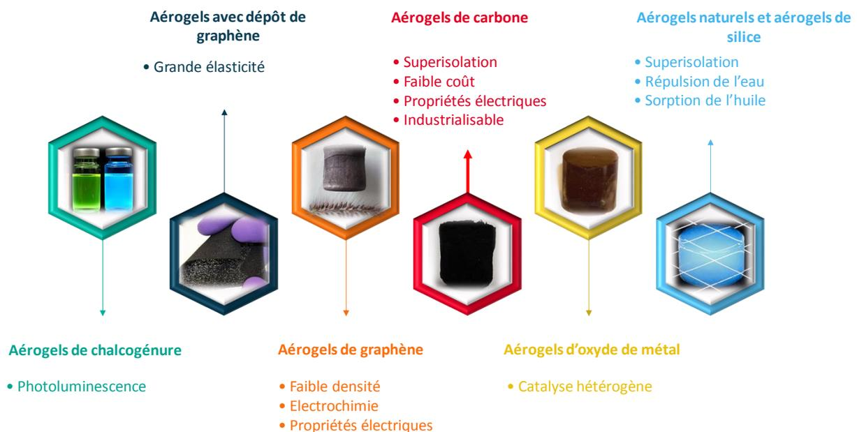
Figure 2 : Quelques exemples de types d'aérogels et leurs propriétés associées
