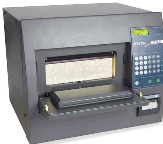
Figure 53 : Photo du fluxmètre HFM 436 de NETZSCH
