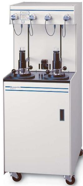
Figure 63 : Photo du porosimètre à mercure AutoPore IV de Micromeritics
