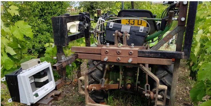
(a) Montage du capteur sur un tracteur vigne
