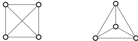
FIGURE 1.15 – Deux représentations du graphe K_4 . La deuxième prouve que K_4 est planaire.
