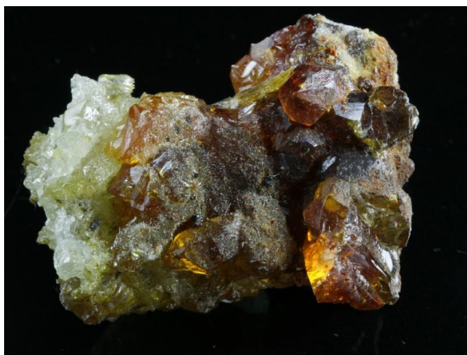
Figure I.1. Photographie de cristaux macroscopiques de ZnO (zincite).
